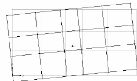
6° modo di vibrazione: Torsione ( T=0,161 s; \tilde{M}_{\%x} = 1,6\% ; \tilde{M}_{\%y} = 0\% )
