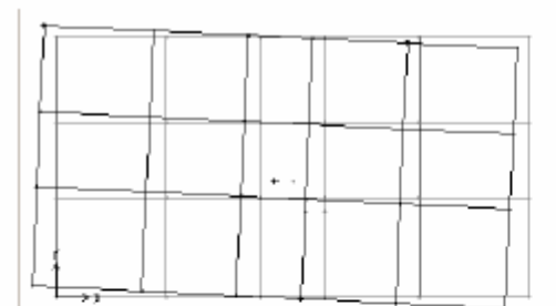
1° modo di vibrazione: Trasl. lungo X ( T=0,591 s; \tilde{M}_{\%x} = 74,6\% ; \tilde{M}_{\%y} = 0\% )
