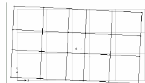
4° modo di vibrazione: Trasl. lungo X ( T=0,197 s; \tilde{M}_{\%x} = 10,2\% ; \tilde{M}_{\%y} = 0\% )
