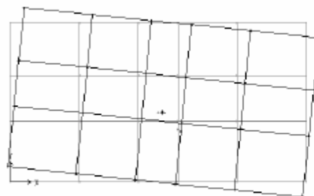
3° modo di vibrazione: Torsione ( T=0,487 s; \tilde{M}_{\%x} = 9,8\% ; \tilde{M}_{\%y} = 0\% )
