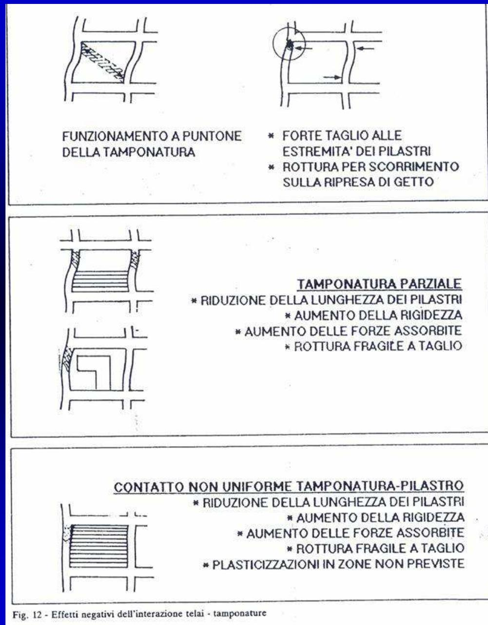
Fig. 12 - Effetti negativi dell'interazione telai - tamponature
