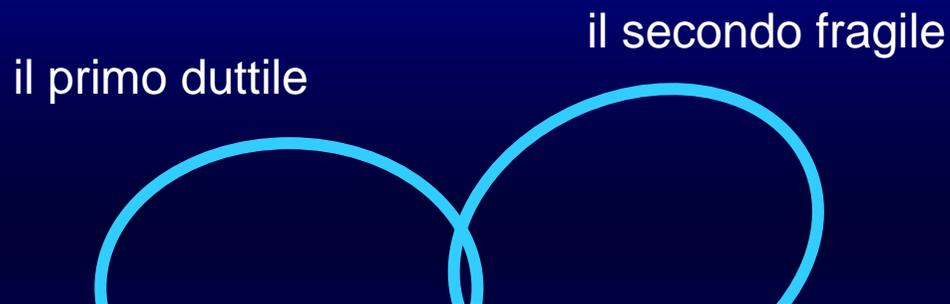
**Nelle strutture la gerarchia delle resistenze va garantita a tutti i livelli strutturali: dei materiali, delle sezioni, degli elementi e dell'intera struttura; ad ogni livello va verificato quale sia il meccanismo duttile e quale quello fragile, e la progettazione deve condurre al sovradimensionamento dei meccanismi fragili.**
