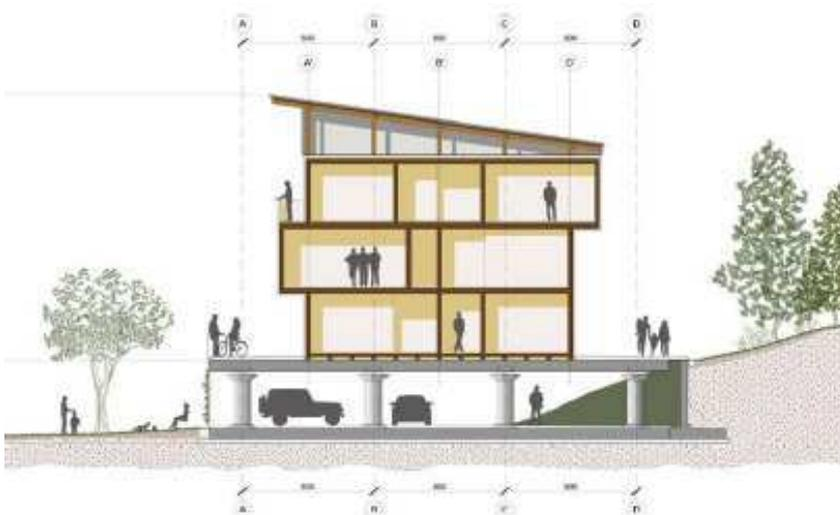
Sezione trasversale dell'edificio prototipo
