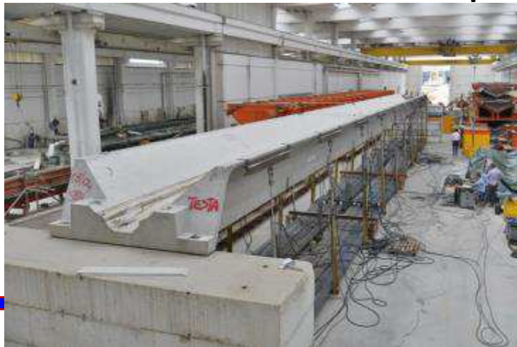
Prova di carico su prototipo e analisi non lineare
