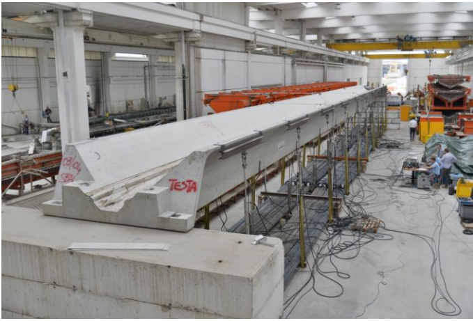
Figure 8. Loading system consisting of 3 jacks on 10 sections, placed at edges and centre / Disposizione dei martinetti di applicazione del carico in 10 sezioni dell'elemento su 3 punti ciascuna, ovvero estremità delle ali e centro.
