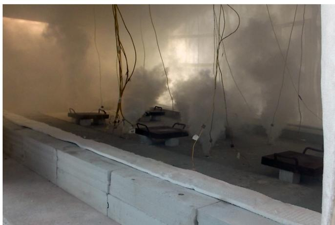
Figure 14. Fire test: EPS burning phase / Prova al fuoco: fase di combustione del nucleo isolante in polistirene.
