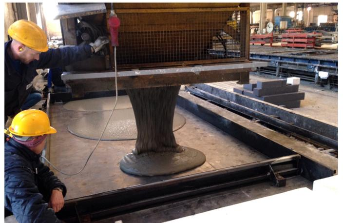
Figure 5. Casting of the HPC intrados layer / Getto dello strato di intradosso in HPC.
