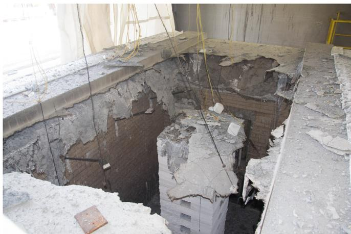
Figure 15. Fire test: collapse due to the HPFRCC spalling / Prova al fuoco: collasso causato dallo spalling distruttivo della piastra superiore in HPFRCC.
