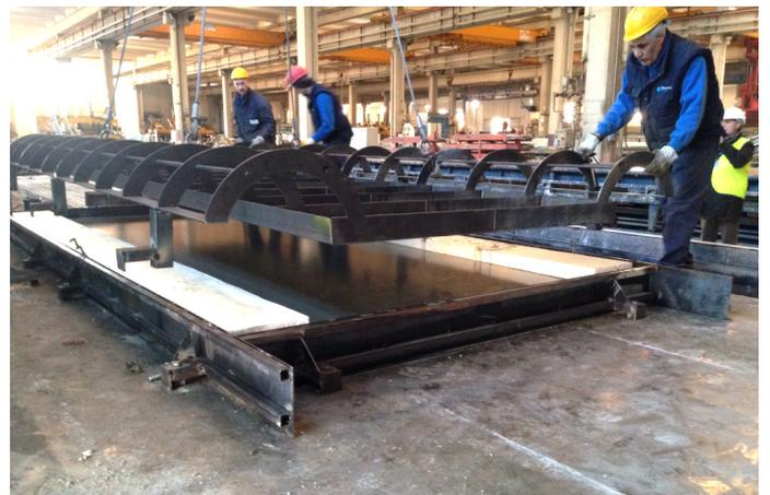
Figure 6. Positioning of the top steel mould / Posizionamento del controscasso superiore in acciaio.
