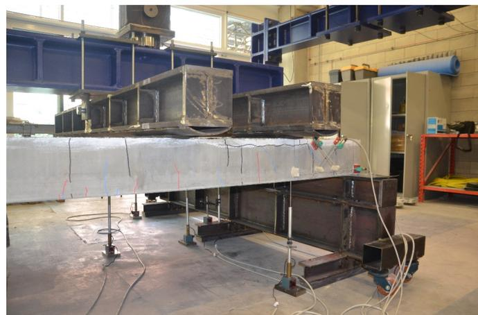
Figure 12. Shear test setup / Apparato di prova a taglio.
