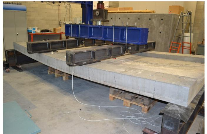
Figure 8. Longitudinal bending test setup / Apparato di prova a flessione longitudinale.
