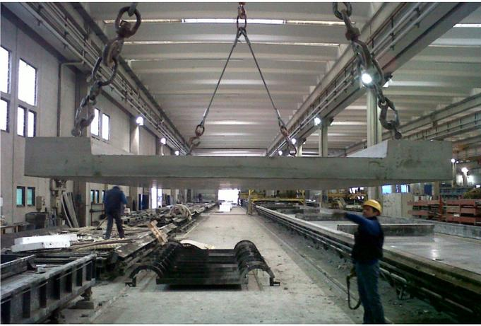
Figure 7. Demolding of the panel prototype / Scassero e movimentazione del prototipo.
