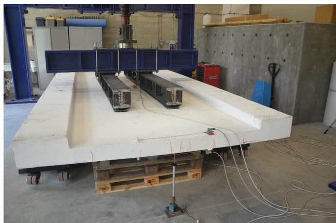
Figure 10. Transverse bending test setup / Apparato di prova a flessione trasversale.
