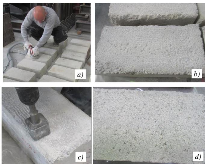
Figure 3. Grinded (a,b) and bush hammered surface (c,d). / Levigatura (a,b) e bocciardatura della superficie (c,d).
