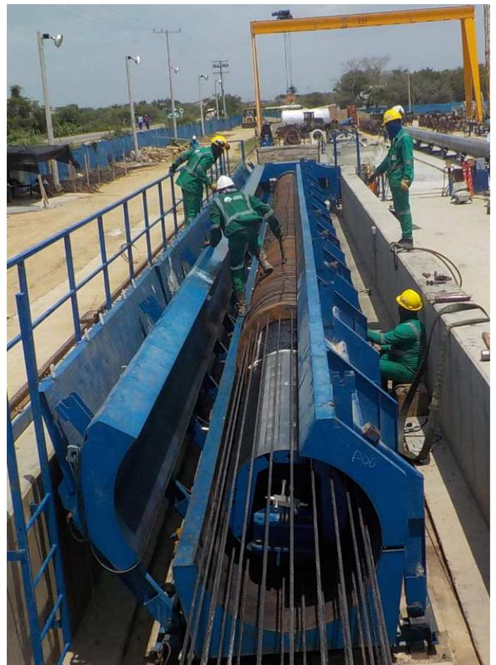
Figure 7. Pile mould / Cassero per la prefabbricazione dei pali.
