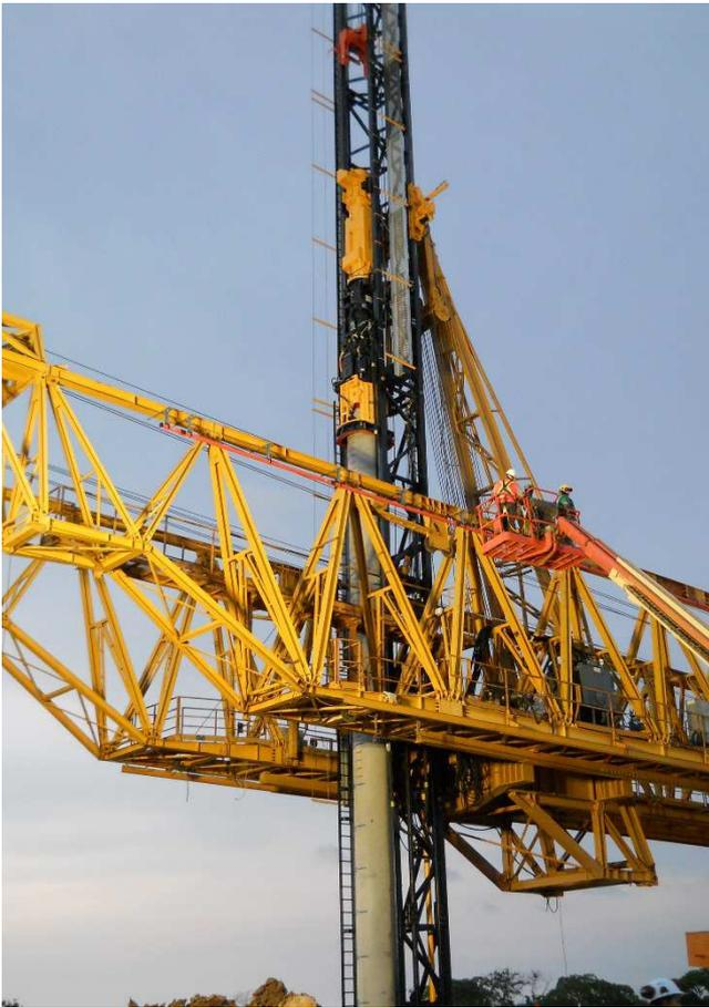
Figure 11. Lead in pile driving configuration / Guida in posizione verticale di battitura.
