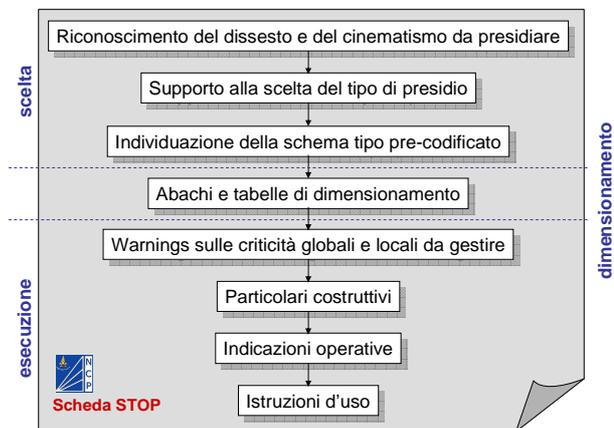
Figura 1 - Struttura logica delle schede STOP.
