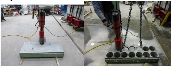
Figura 4.3: fasi di carotaggio.
