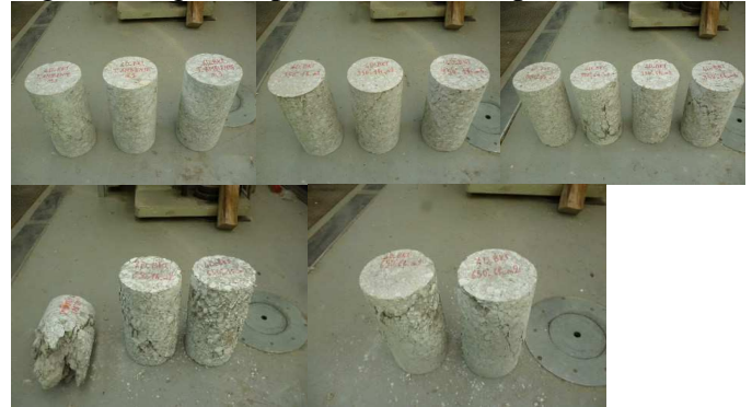
Figura 5.3: campioni testati: (a) T ambiente; (b) e (c) 350^{\circ}C , 1° e 2° modalità; (d) e (e) 650^{\circ}C , 1° e 2° modalità;
