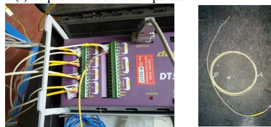
Figura 4.6: (a) Sistema di acquisizione – Data logger; (b) termocoppia.
