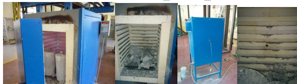
Figura 5.2: (a) e (b) conseguenze dell'esplosione; (d) e (e) termocoppia interna al forno.
