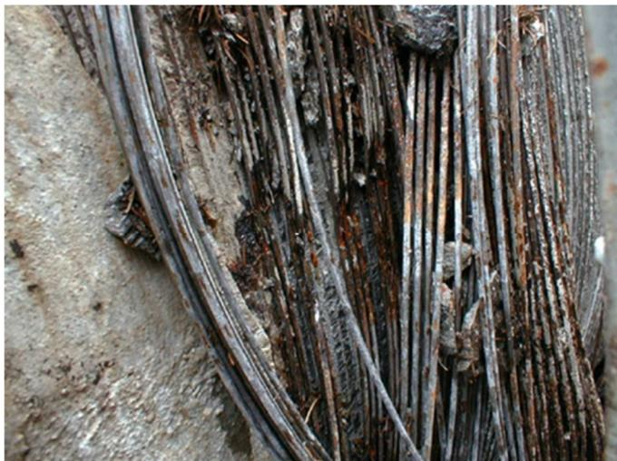
Figure 12. Damaging and corrosion of a CAP pipe / Danneggiamento e corrosione su una condotta in CAP.
