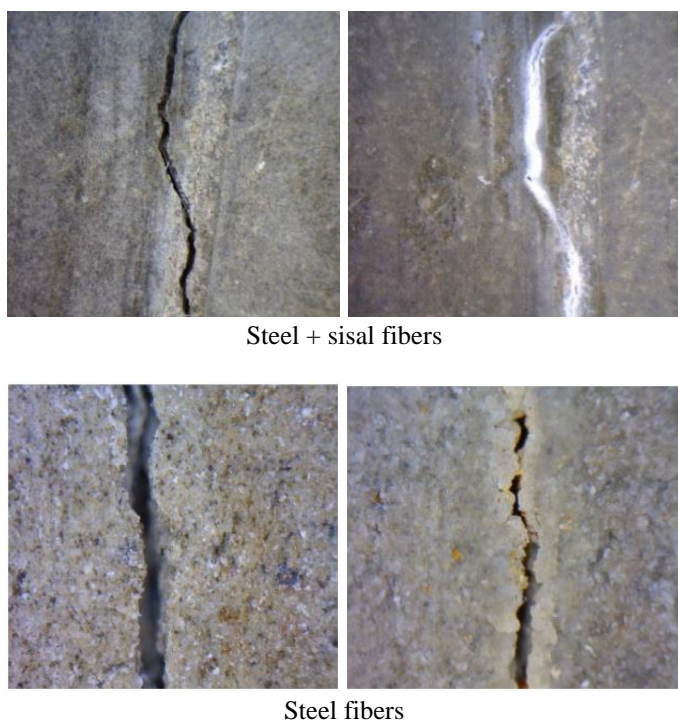
Figure 15: completely healed cracks in steel+sisal (a) HPFRCC deflection softening specimens after 3 months wet/dry cycling and of partially healed cracks in steel (b) HPFRCC deflection softening specimens after 6 months cycling (0.5 mm pre-crack - different magnification)/richiusura completa della fessura in provino HPFRCC degradante con fibre di acciaio e sisal dopo 3 mesi di cicli asciutto/bagnato e fessura parzialmente richiusa in provino HPFRCC con fibre di acciaio dopo 6 mesi di cicli asciutto bagnato (prefessurazione 0.5mm-scale diverse)
