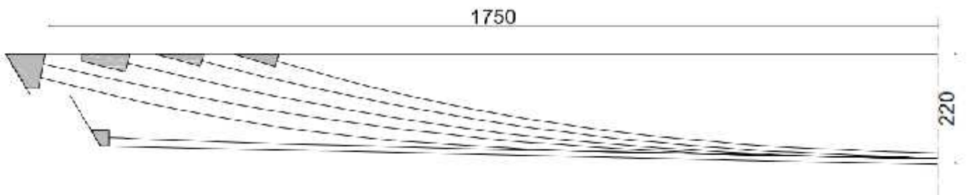
Figure 5. Prestressed wires in the external longitudinal beams/ Cavi di precompressione nelle travi longitudinali esterne
