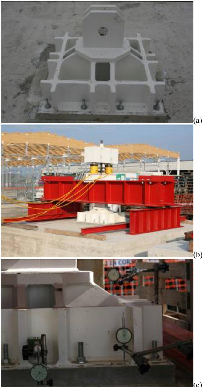
Figure 7. Tests on anchor groups: (a) stiffened load transferring element; (b) test set-up and (c) locations of gauges C5 (foreground), C2 (bottom right) and C3 during test G1 / Prove su ancoranti in gruppo: a) Elemento di ripartizione del carico; (b) configurazione di prova e (c) posizioni dei comparatori C5 (in primo piano), C2 (in basso a destra) e C3 nella prova G1.
