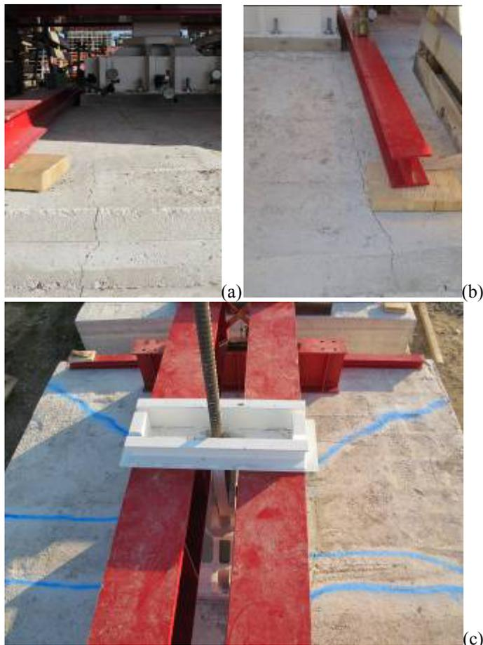
Figure 9. (a, b, c) Crack pattern observed during test G1 / (a, b, c) Quadro fessurativo osservato nel corso della prova G1.
