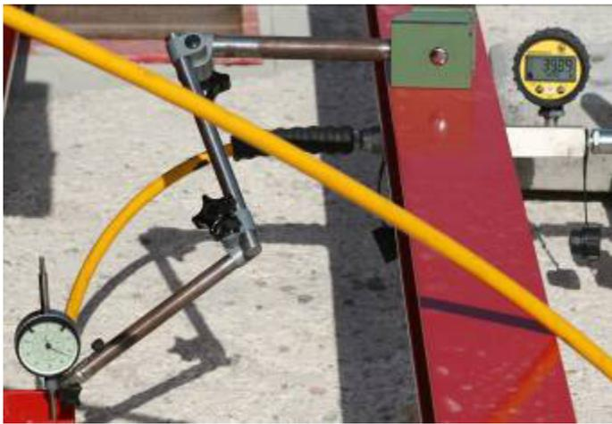
Figure 2. Manometer and comparator gauge C1, test S2 / Manometro e comparatore centesimale C1, prova S2.
