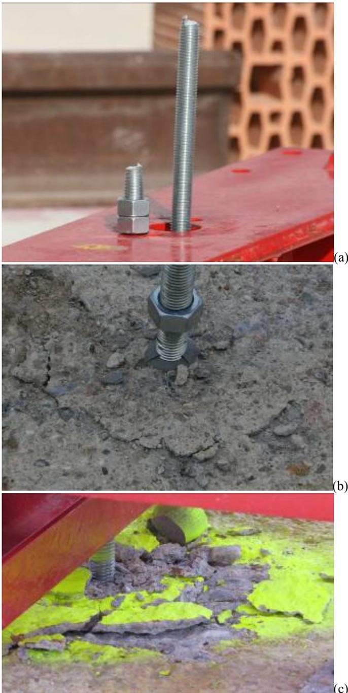
Figure 3. (a) Broken threaded rod at the end of test S2 and concrete failure observed in tests (b) S5 and (c) S8 / Rottura della barra filettata al termine della prova S2 e rottura del calcestruzzo osservata nel corso delle prove (b) S5 e (c) S8.
