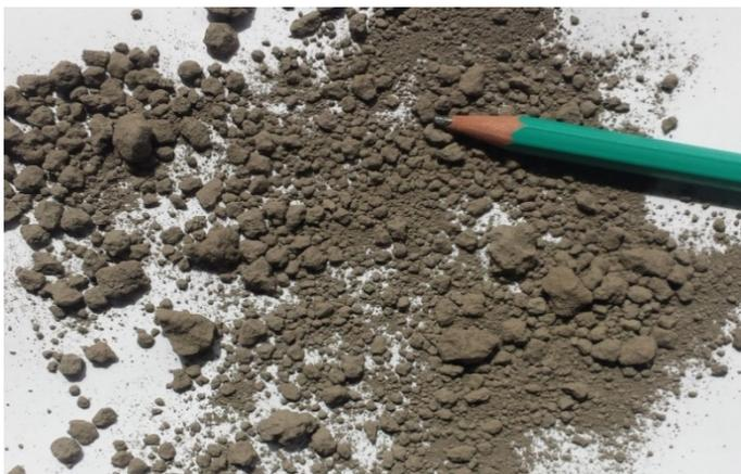
**Figure 5.** Pozzolana granules, with humidity content round 20% / Pozzolana granulare, con contenuto di umidità del 20% circa
