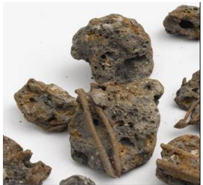
**Figure 1.** Samples of bottom ash with bounded metal scraps: it should be noted that it appears like a volcanic rock / Campioni di scorie: si notino i rottami metallici legati alla scoria fusa con aspetto del tutto simile ad una roccia vulcanica
