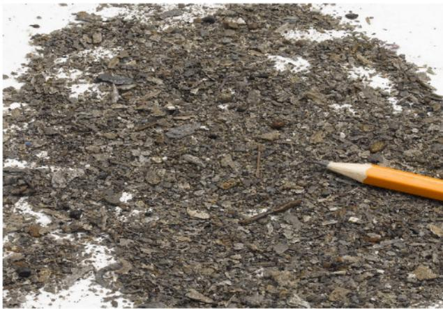
**Figure 2.** Non ferrous metal scraps of very fine dimension recovered from MSWIBA / Rottami metallici "non ferromagnetici" di piccolissime dimensioni separati dalle scorie
