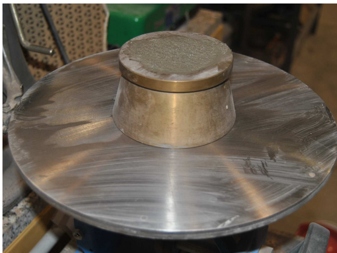
Figure 5. Determination of workability of mortars (UNI EN 1015-3)/ Determinazione della lavorabilità delle malte (UNI EN 1015-3)
