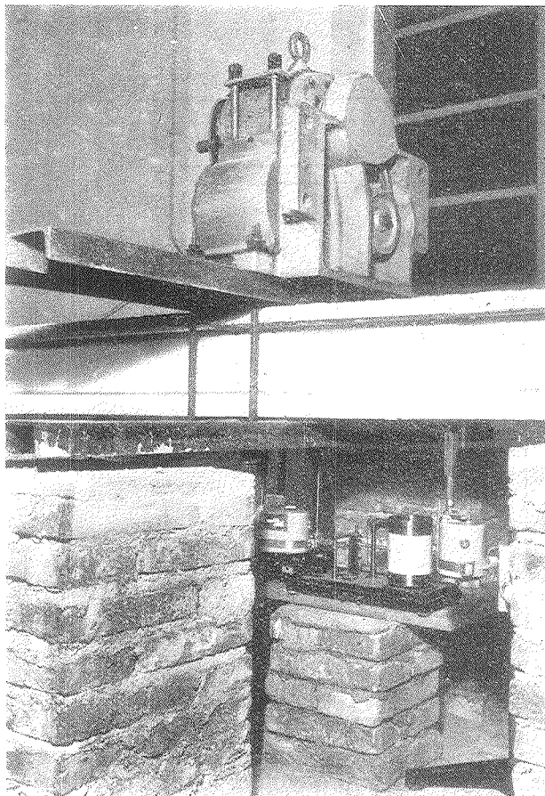
FIG. 5. — Vibrodina applicata alla trave. Registratori Askania e Rabut.
