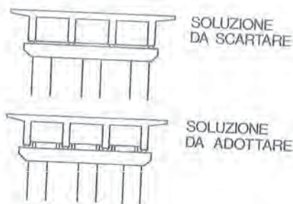
Fig. 6 - Sollevabilità dai trasversi di testata
