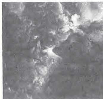
Foto 6 - Contatto tra la pasta di cemento (1) ed un granulato (2) - Rottura intergranulare - Calcestruzzo testimone
