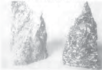
Foto 8 - Rottura intergranulare, provino a sinistra testimone - Rottura transgranulare, provino a destra con microsilica modificata
