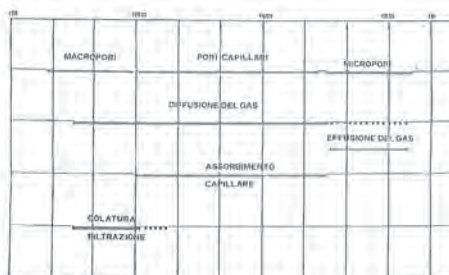
Graf. 7 - Ampiezza della porosità del calcestruzzo e meccanismi di trasporto dei liquidi.
