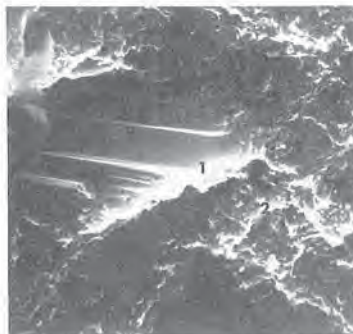
Foto 5 - Cristallo massivo di \text{Ca}(\text{OH})_2 (1) attoniato dal C-S-H(2)
