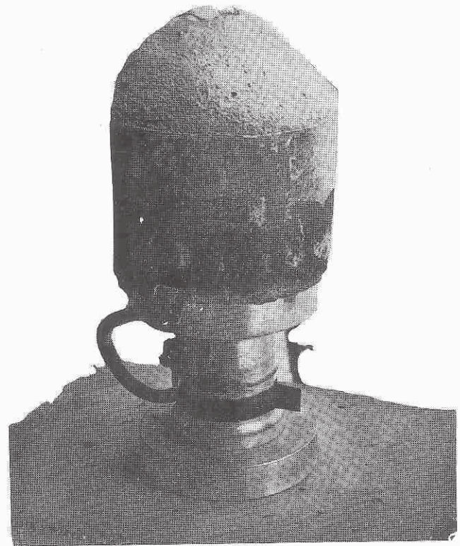
Fig. 61 - Testata: cono Freyssinet e dinamometro
