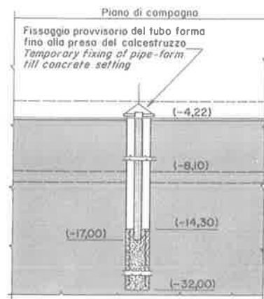
III - Perforazione pali \varnothing 800, per i pilastri interni, eccetto i 5 centrali, con tolleranza dell'1% sull'inclinazione. Getto di calcestruzzo fino a quota -14,30. Fissaggio del tubo-forma e getto di riempimento
