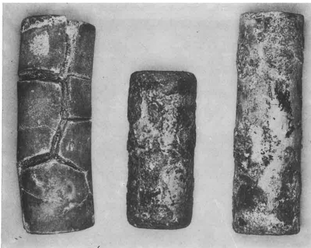
Fig. 2 A sinistra un provino di calcestruzzo degradato per immersione in acqua solfatica (3000 ppm); a destra un provino di calcestruzzo resistente all'azione dei solfati. Nel centro é mostrato un provino sottoposto a dilavamento con acqua contenente anidride carbonica aggressiva.
