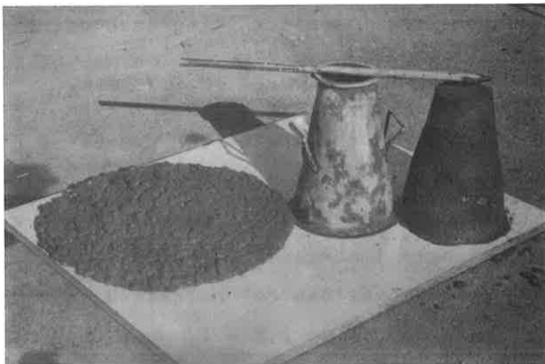
Fig. 9 - Abbassamento al cono del calcestruzzo asciutto (senza additivo) e di quello reoplastico (con Rheobuild 561) con composizione della Tabella 1.
