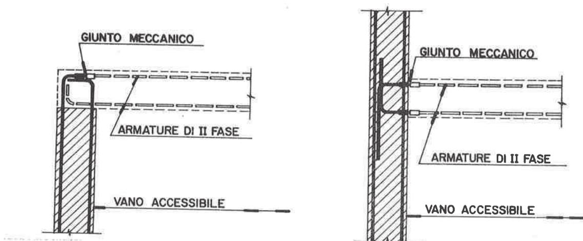
Fig. 9 - Ripresa di armature con giunto meccanico
