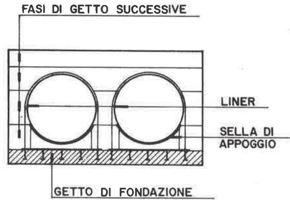
Fig. 5 - Fasi di Costruzione delle Tubazioni di Mandata
