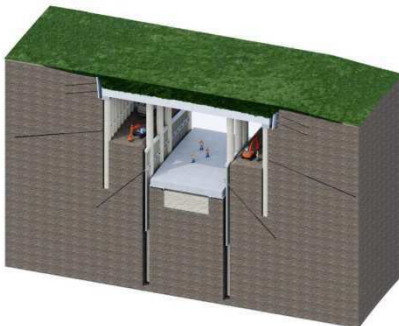
5 Realizzazione soletta asse principale, ritombamento e ripristino quota campagna iniziale
