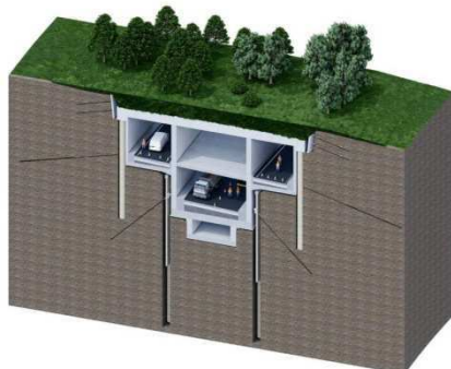
7 Realizzazione pacchetto stradale e segnaletica
