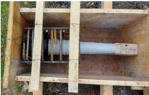
Figura 6: Prove di lavorabilità e di getto: armatura di frettaggio delle testate di post-tensione (a) e fase di getto (b)
