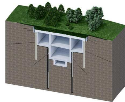
6 Realizzazione gusci, demolizione pali discreti centrali
