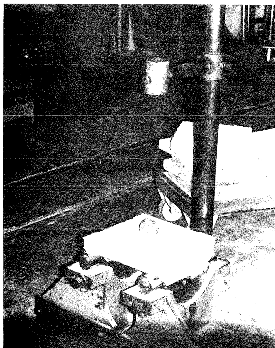
Fig.2 - Prova di urto con dispositivo a massa cadente
