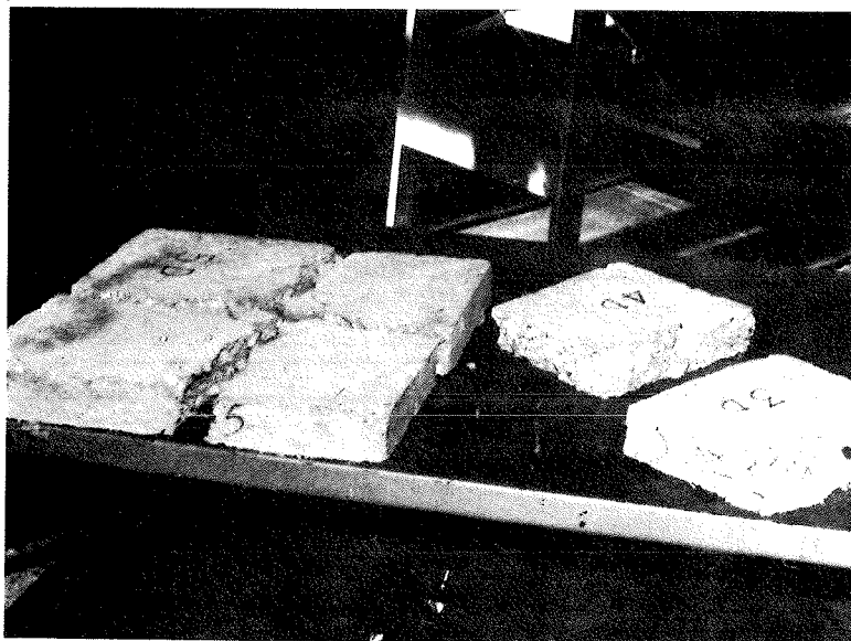
Fig.6 - Lastre 300x300x40 mm sottoposte alla prova di urto con la massa cadente
