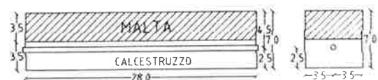
PROVINO TIPO A CLS + 1% DI CLORURI MALTA DI RESTAURO CON SENZA MCI
