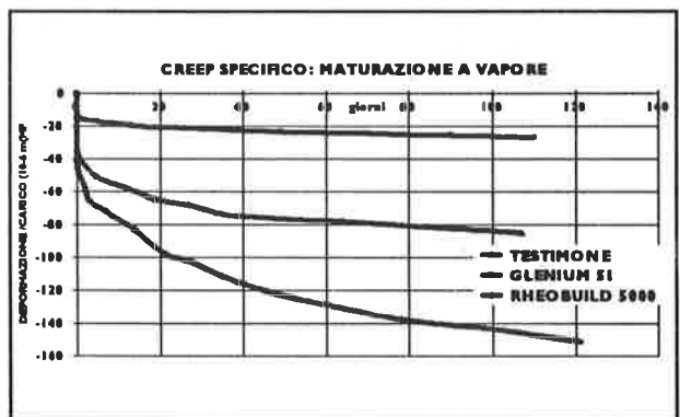
Figura 12: Creep specifico in condizioni di maturazione a vapore per calcestruzzo tipico utilizzato in prefabbricazione rispettivamente dall'alto verso il basso con, gli additivi della famiglia CE, con superfluidificante e tal quale senza additivi
