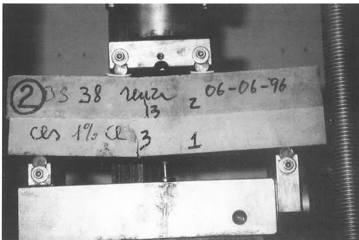
Fig. 5-Modalità di rottura del provino con malta di restauro BS 38 senza MCI
