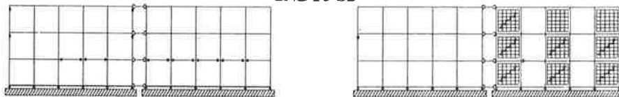
Fig. 8 - Localizzazione cerniere plastiche formatesi nella struttura
