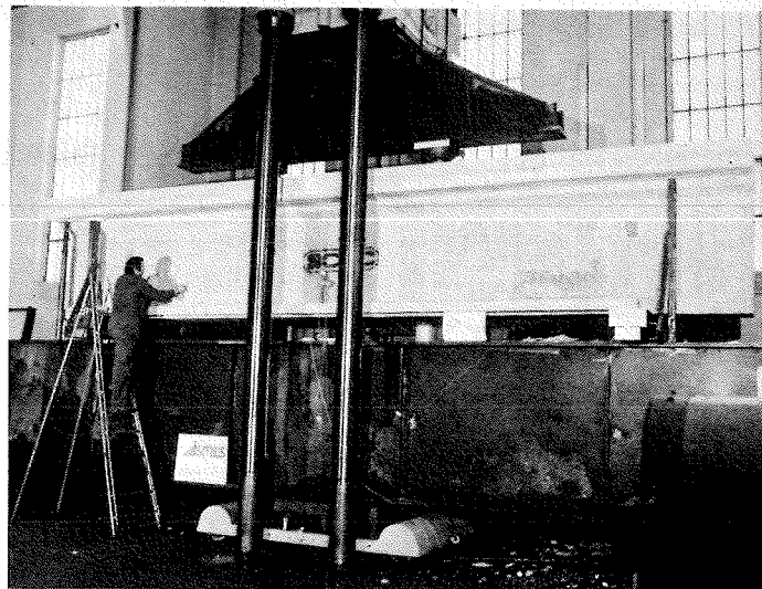
3 - Prova di carico per la determinazione del meccanismo di collaudo per taglio di una trave in c.a.p.
