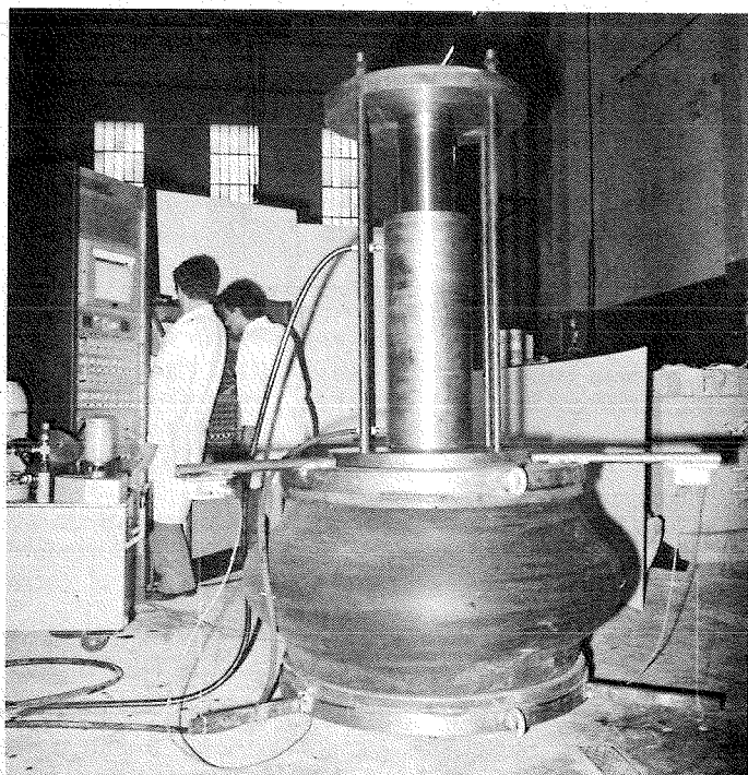
2 - Prova di carico per la determinazione della capacità di dissipazione d'energia di uno smorzatore.
