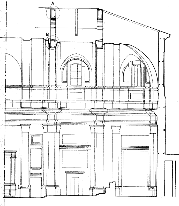
49 - Chiesa di S. Francesco alle scale - Ancona: Sezione verticale sull'arco dell'abside e rafforzamento dell'arco.
