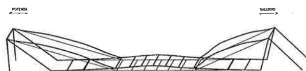
Figura 9 - Deformata modale 1.33 Hz
