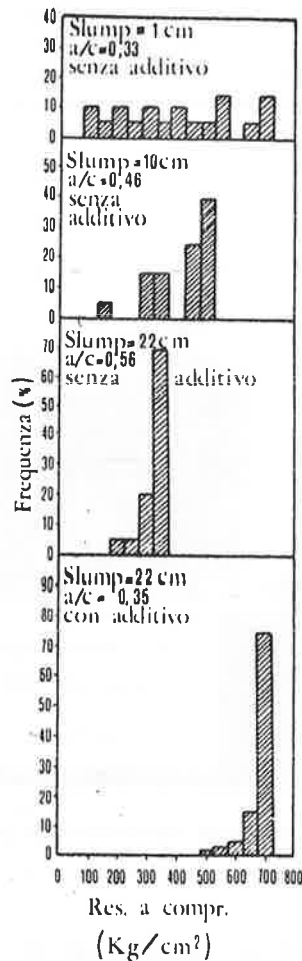
Fig. 8.11 - Influenza della lavorabilità sulla dispersione dei risultati di resistenza meccanica per calcestruzzi ordinari compattati per tempi diversi (154).
