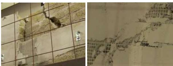
Figura 7 – Danneggiamento del campione a fine prova: dettagli
