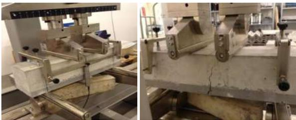
Figura 6 – Set-up di prova di flessione a 4 punti in controllo di spostamento sui provini rinforzati con UHPFRC
