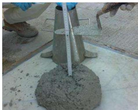
Figura 7 – Slump test della miscela con fibre riciclate
