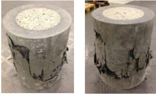
Figura 9 – Modalità di collasso di provini cilindrici incamiciati con uno strato di rinforzo in UHPFRC sottoposti a prova di compressione
