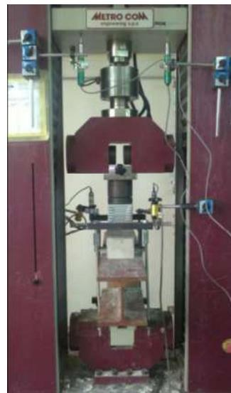
Figura 3 – Prova di taglio
