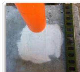
Figura 17 – Quarzo per l'aderenza del provino
