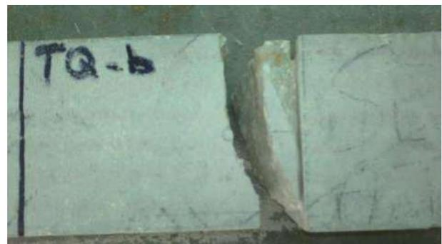
Figura 15 – Modalità di crisi per i campioni TQ\_A e TQ\_B
