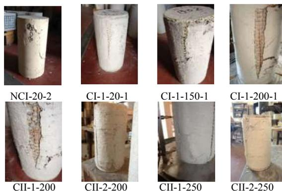
Figura 3. Modalità di rottura dei provini
