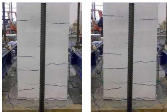
Figure 12. Campione CJ in corrispondenza di un drift dello 0.75% e al termine della prova
