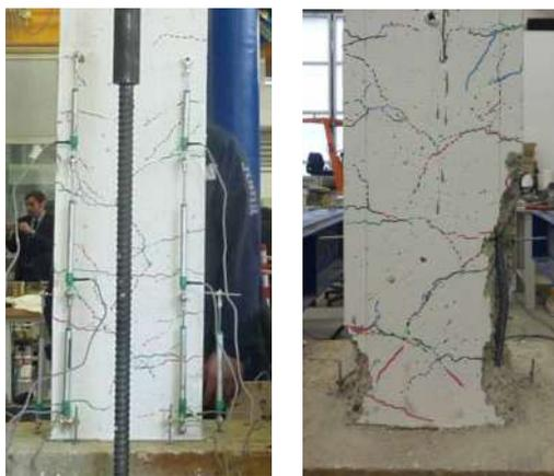
Figure 10. Campione CNC in corrispondenza di un drift del 2% e al termine della prova
