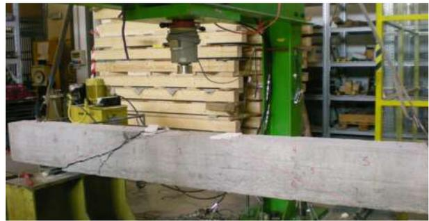
Figura 8 - Rottura a taglio della trave B2\_2
