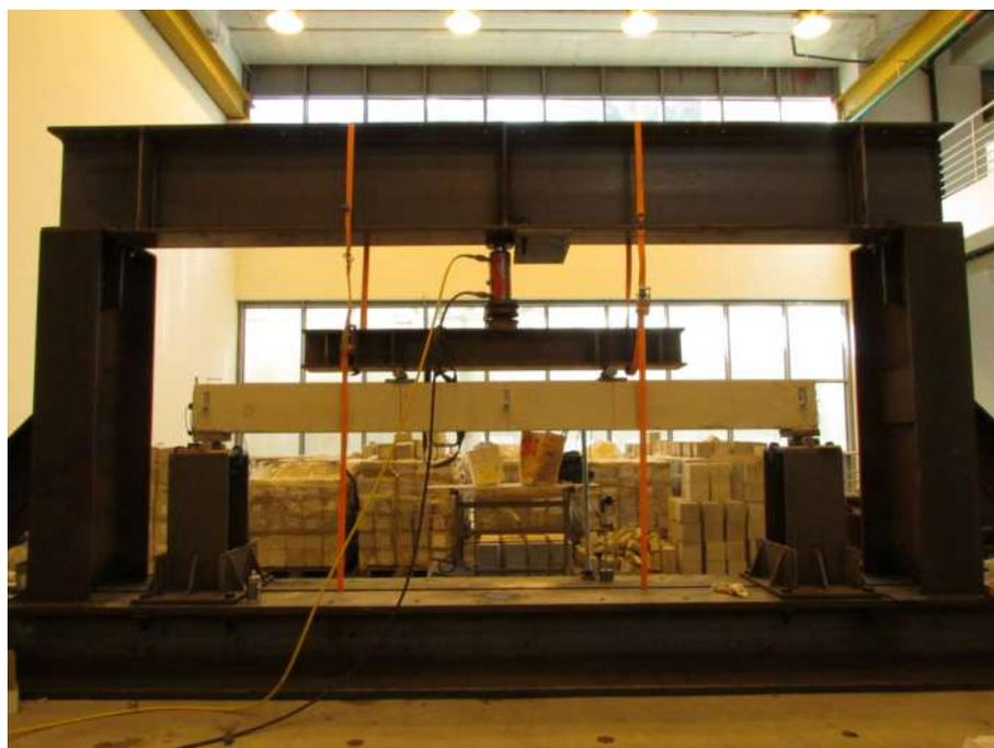
Figura 3 – Telaio di contrasto e setup di prova
