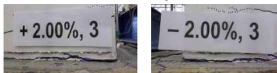
Figure 13. Campione CJ. Danneggiamento localizzato all'interfaccia colonna - fondazione
