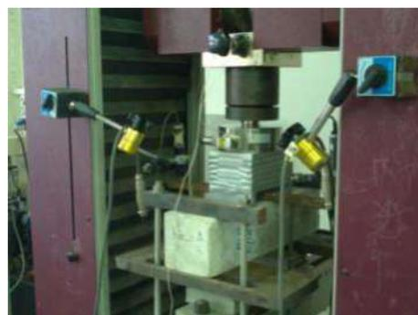
Figura 5 – Set-up di prova a taglio
