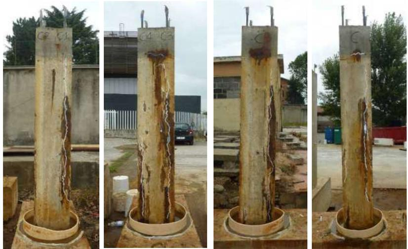
Figura 2 . a) Cella elettrolitica utilizzata per il processo di corrosione artificiale; b) Quadro fessurativo di uno dei due pilastri al termine del processo di corrosione delle barre di armatura
