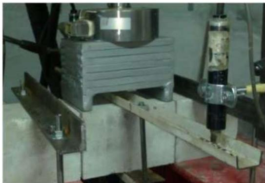
Figura 6 – Particolare del set-up di prova a taglio
