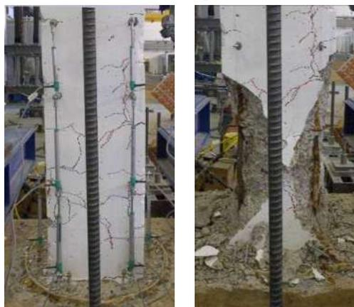
Figure 11. Campione CC in corrispondenza di un drift del 2% e al termine della prova
