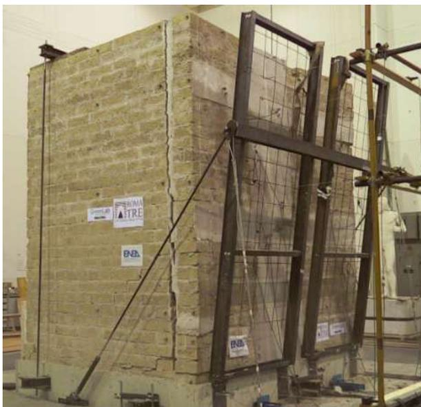
Figura 6 – Danneggiamento del campione a fine prova
