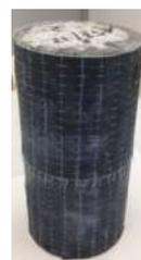
Figura 4: Provini RC incamiciati con FRP in singolo strato (configurazione Tipo A).
