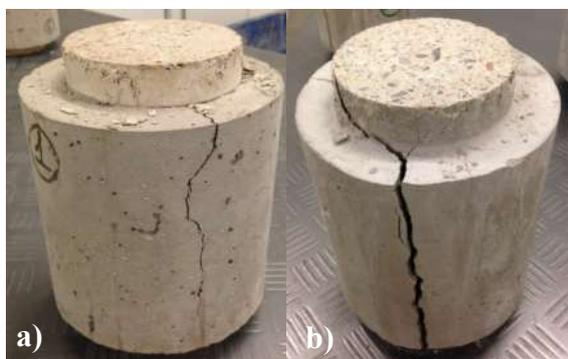
Figura 11 – Provini bistrato dopo riscaldamento e test di compressione tipologia B: a) bistrato con UHP-FRC, b) bistrato con MRC
