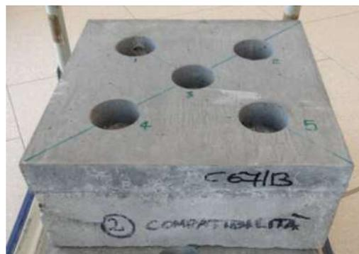
Figura 2 – Piastra in calcestruzzo secondo UNI EN 1766, rinforzata superiormente con uno strato di 30 mm di UHPC, dopo l'esecuzione delle prove di pull-off
