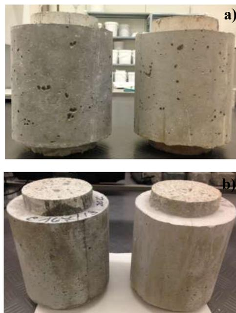
Figura 9 – Provini bistrato prima e dopo riscaldamento tipologia B: a) bistrato con UHP-FRC (20°C-provino di sinistra, 300°C-provino di destra), b) bistrato con MRC (20°C- provino di sinistra, 300°C- provino di destra)
