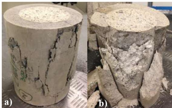
Figura 10 – Provini bistrato dopo riscaldamento e test di compressione tipologia A: a) bistrato con UHP-FRC, b) bistrato con MRC
