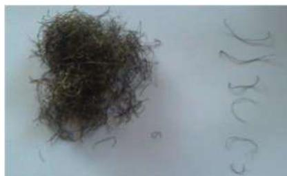
Figura 1 – Fibre da riciclo di PFU
