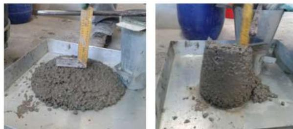
Figura 3 - Abbassamento al cono di Abrams, Mix RAC20/0.4-1.0 e Mix EMV20/0.4-1.0
