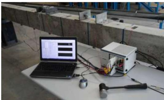
Figura 9 – Sistema di acquisizione dei segnali, martello strumentato e trave di prova per i test di vibrazione.
