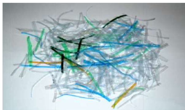
Figura 6 – Fibre di PET dopo l'azione di strappo
