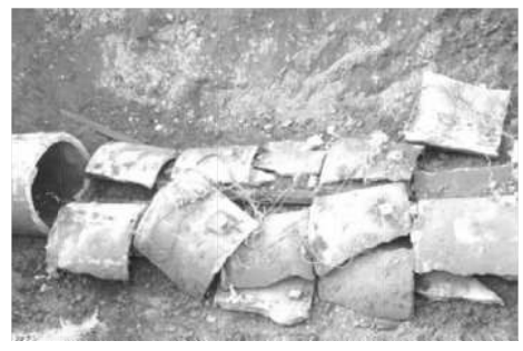
Figura 7. Test esplosivo sul tubo interrato: (a, b) misure estensimetriche circonferenziali in tre sezioni poste a differente distanza dalla sorgente come indicato e per le due cariche esplosive provate; (c) quadro fessurativo; (d) tubazione a collasso
