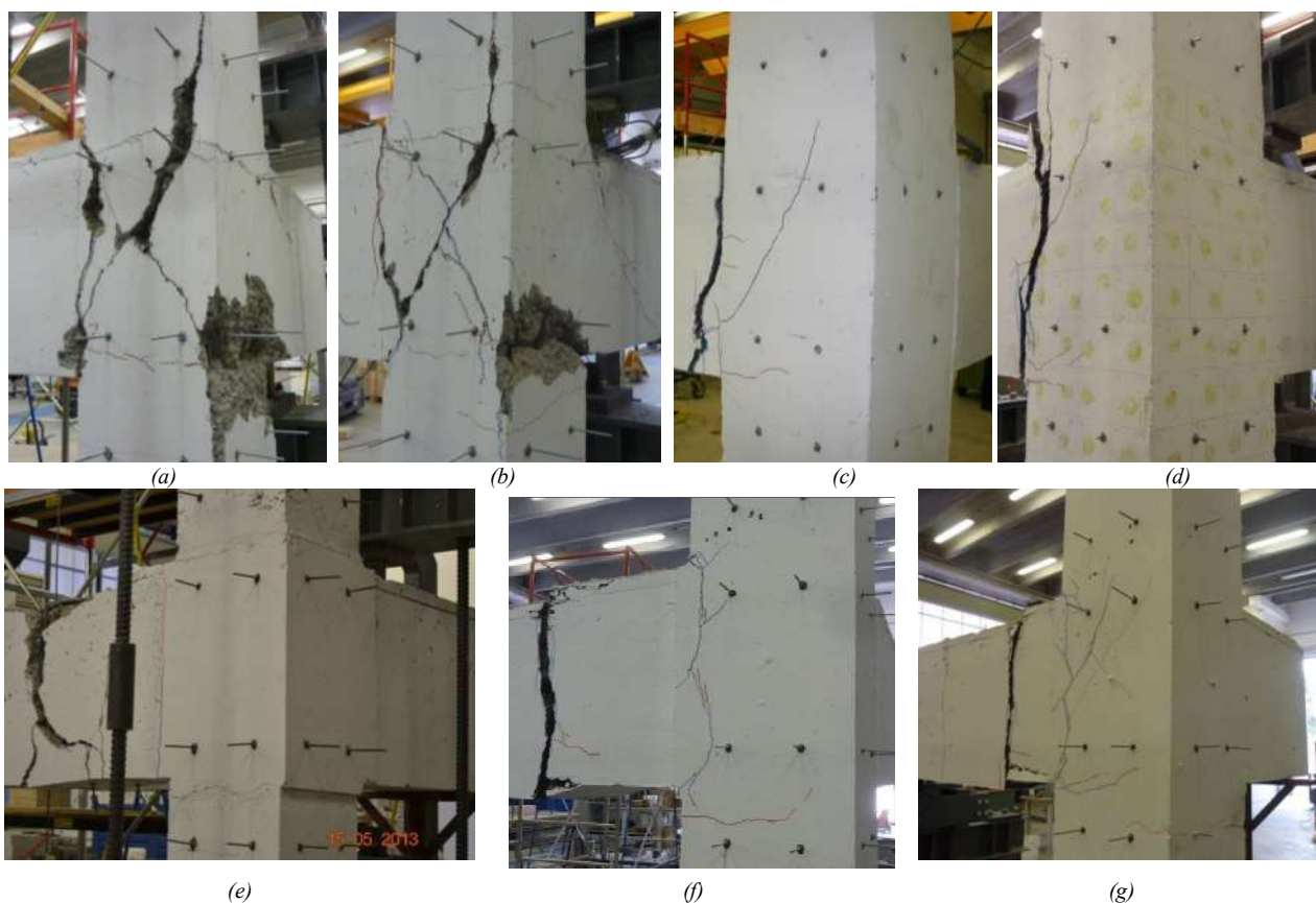
Figura 5 - I campioni al termine delle prove: (a) CJ1; (b) CJ2; (c) RCJ1; (d) RCJ2; (e) GRCJ; (f) HGRCJ; (g) D-HGRCJ
