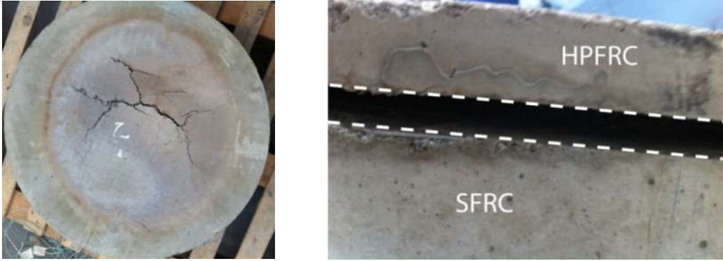
Figura 8. Test al fuoco del solaio panino: Quadro fessurativo dopo la scheggiatura
