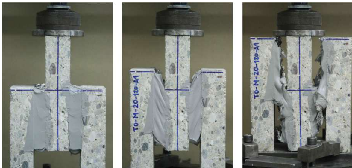
Figura 8. Modalità di rottura di un provino sottoposto a prova monotona: (a) configurazione in deformata; (b) ingobbamento laterale per grandi deformazioni; (c) collasso.
