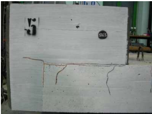
Figura 12. Panorama fessurativo in corrispondenza del carico massimo – prove 3, 4, 5 e 6
