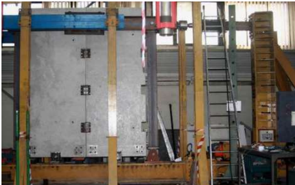
Figura 13 – Impianto di prova con assieme strutturale assemblato.
