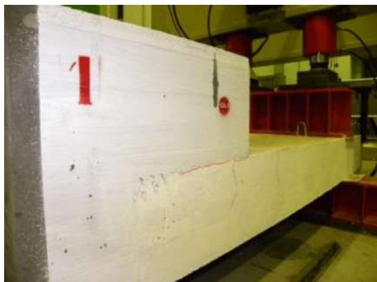
Figura 9. Panorama fessurativo: carico di 45 kN
