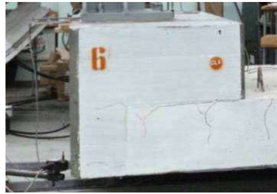
Figura 12. Panorama fessurativo in corrispondenza del carico massimo – prove 3, 4, 5 e 6
