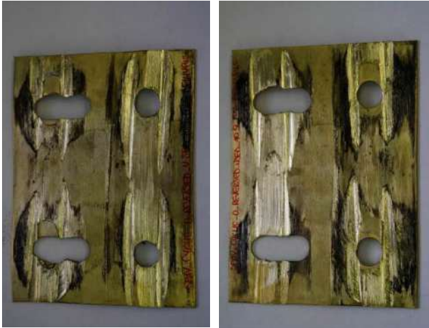
Figura 6. Piastrine di ottone dopo dieci cicli di abrasione con massima ampiezza di spostamento
