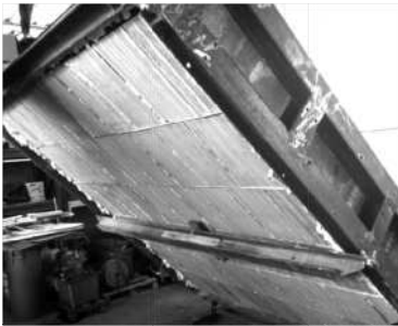
Figura 9 – Prova di ribaltamento della parete finita
