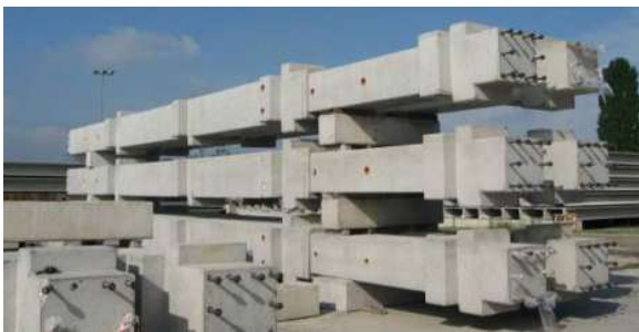
Figura 15 - Stoccaggio pilastri prefabbricati
