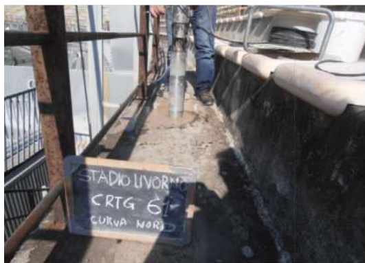
Figura 6 – Carotaggio della soletta dei gradoni (marzo 2014)
