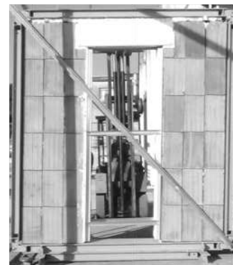
Figura 7 – Campione di tamponatura confinata per la prova di taglio
