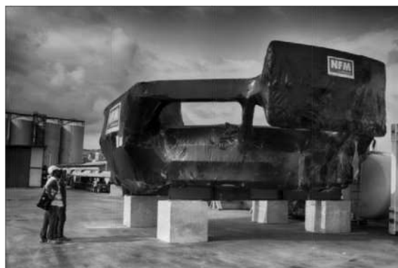
Figura 7 - Componente di maggior peso della TBM
