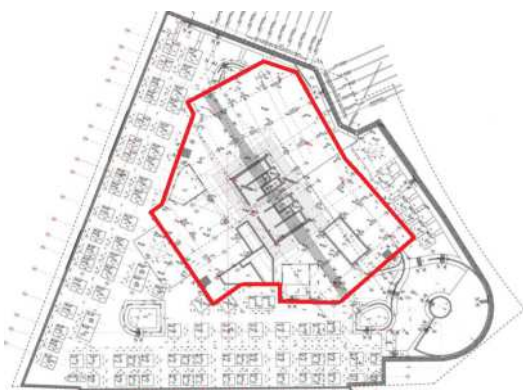
Figura 2 – Platea di fondazione della Torre Park Tower
