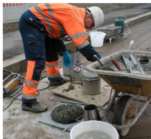
Figura 8 - Controlli cls fresco per getto platea
