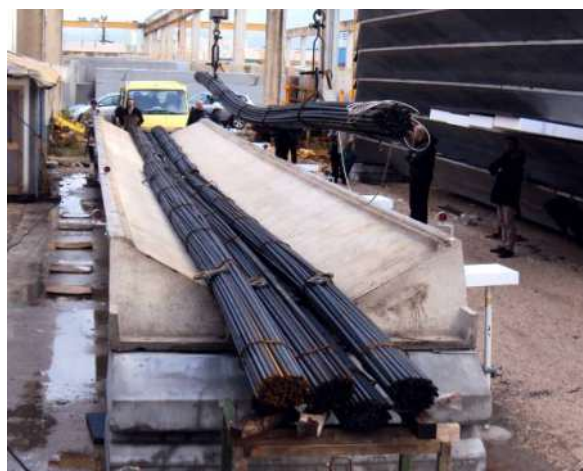
Figura 7 – Fase di carico del tegolo 1
