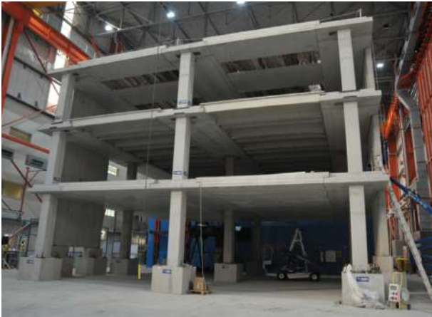
Figura 1 – Prototipo del progetto “SAFECAST” nel laboratorio ELSA del Centro Comune di Ricerca di Ispra.
