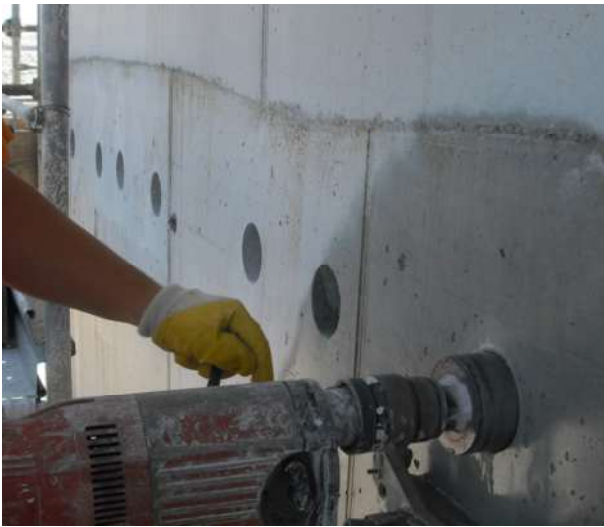
Figura 9 – Mock-up: estrazione delle carote cilindriche.
