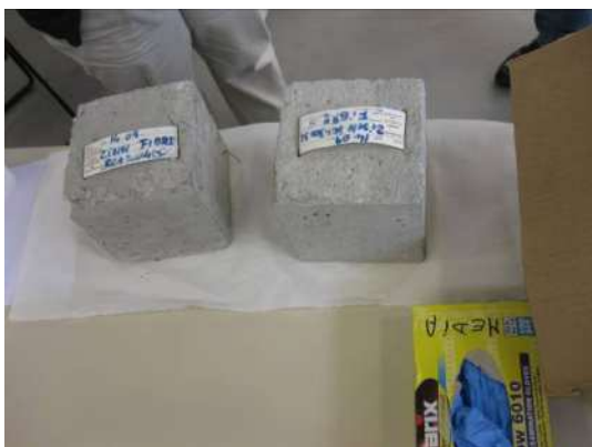
Figura 3 Provini contrassegnati (e già portati a rottura, ma apparentemente integri grazie alle fibre)
