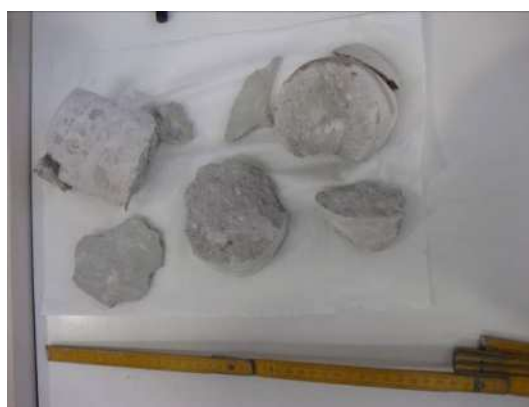
Figura 4 Carote di calcestruzzo estratte da una pavimentazione ammalorata
