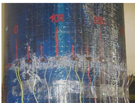
Figura 5- Strain gauges lungo il perimetro della colonna confinata
