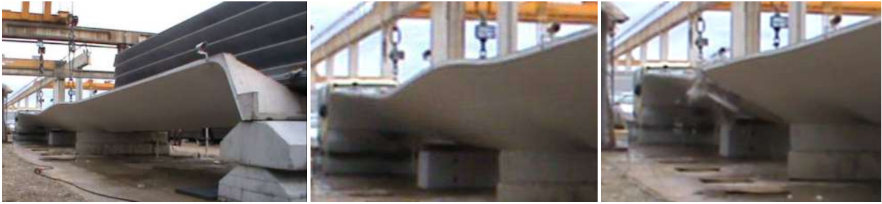
Figura 11 – Sequenza di collasso del tegolo 1
