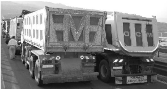
Figura 18 - Autocarri durante una prova di carico
