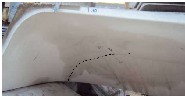
Figura 5 – Lesione a 45° all'estremità del tegolo 1
