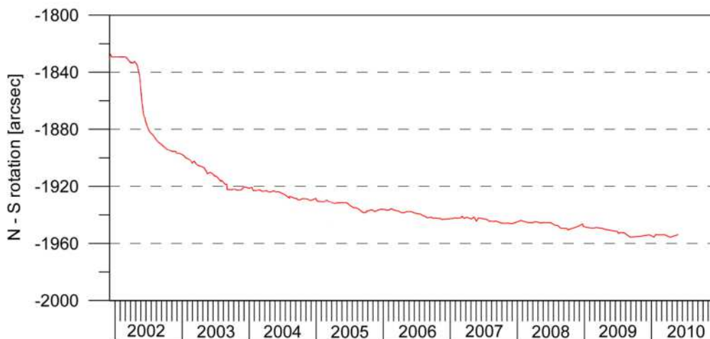
Figura 3 – Rotazioni misurate mediante livellazione interna nel piano Nord-Sud
