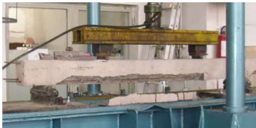
Fig.5– Relazioni momento-freccia sperimentali e modalità di rottura a taglio-aderenza.
