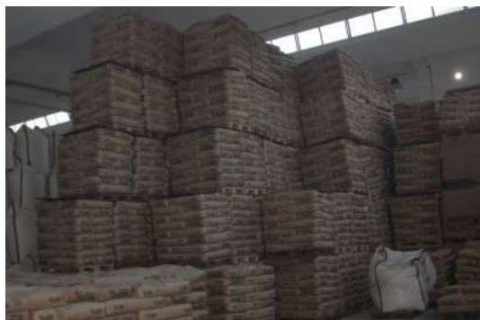
Figura 6 Stoccaggio anomalo (carico eccessivo) all'interno di un capannone industriale
