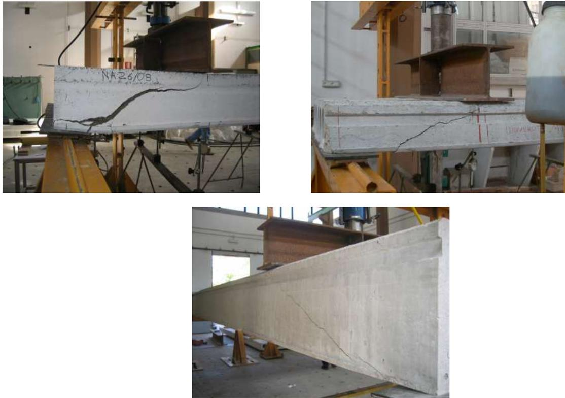
Figura 8 - Comportamento a rottura taglio-trazione delle lastre NA26, TH20, TH40
