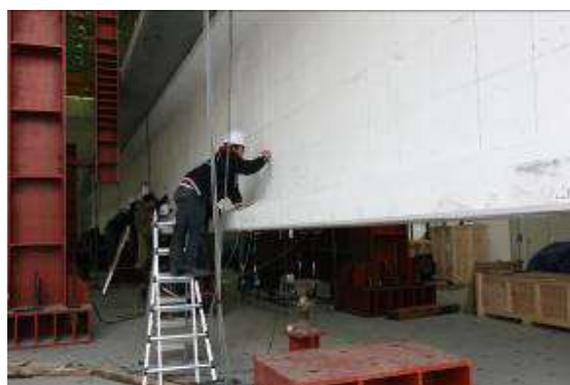
Figura 9: Rilevamento delle fessure
