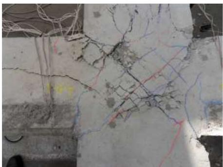
Figura 12 – Particolare del pannello del nodo N. 4 dopo la prova
