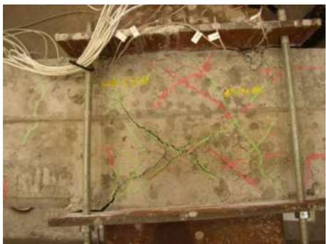
Figura 13 – Particolare del pannello del nodo N. 5 dopo la prova
