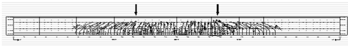
Figura 10: Distribuzione delle fessure a 3000 kN
