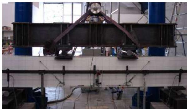
Figura 8 – Strumentazione faccia anteriore della trave
