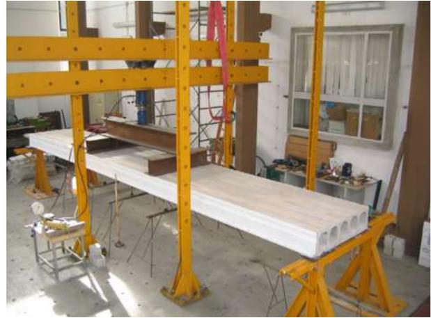
Figura 2 - Disposizione del carico per la prova di flessione su quattro punti
