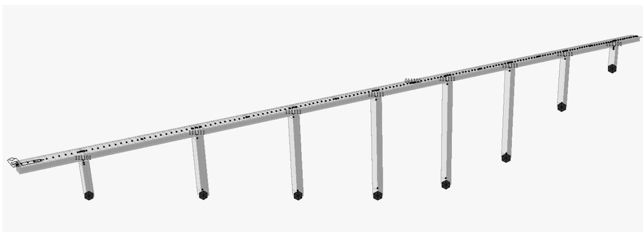
Figura 5 – Viadotto "Navile": modello di calcolo F.E.M.
