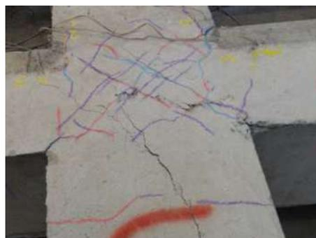
Figura 10 – Particolare del pannello del nodo N. 2 dopo la prova
