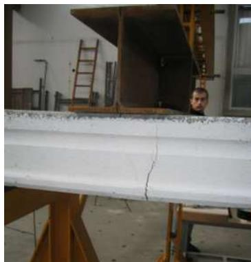
Figura 7 - Comportamento a rottura taglio-flessione delle lastre H30G, H25G, H20H, H40G, FA42, FA33, NA20
