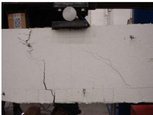
Figura 15 – Distribuzione delle fessure al collasso per la trave E
