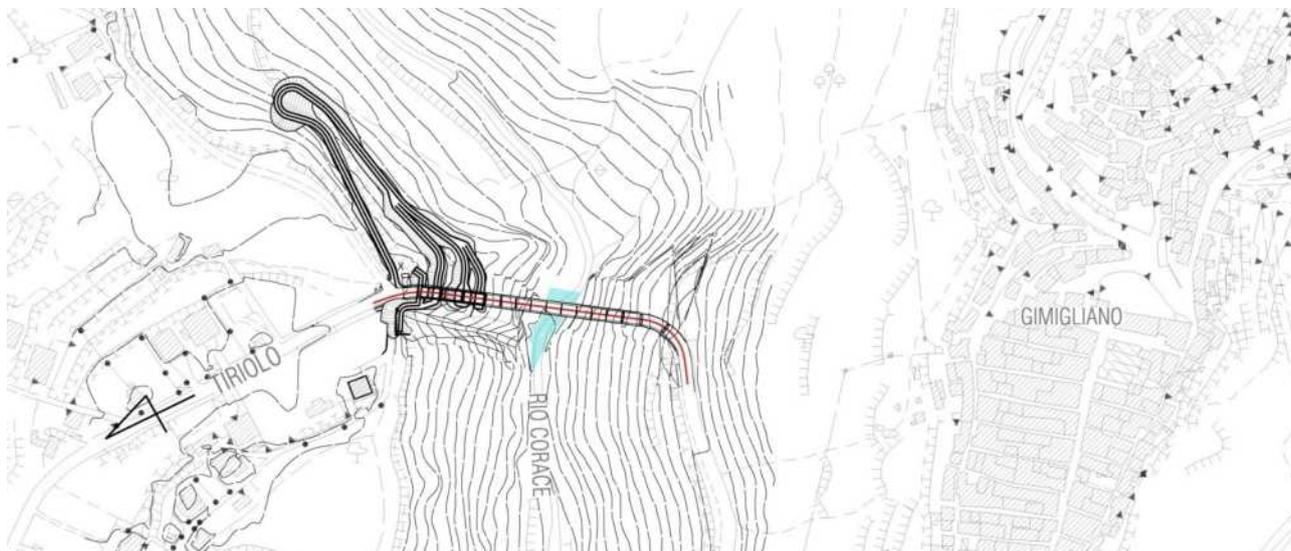
Fig. 11 Planimetria della strada di accesso alla base delle pile
