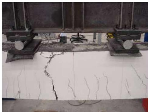
Figura 19 – Distribuzione delle fessure al collasso per la trave B
