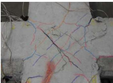
Figura 11 – Particolare del pannello del nodo N. 3 dopo la prova
