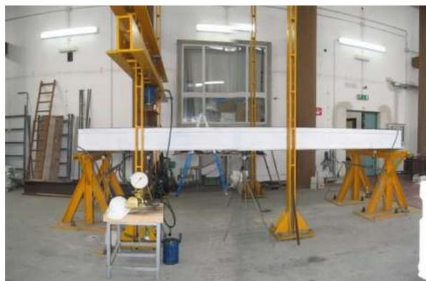
Figura 6 - Disposizione del carico per la prova di taglio
