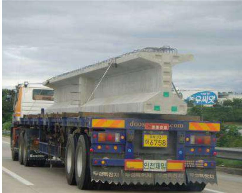
Figura 4: Trasporto del segmento in cantiere
