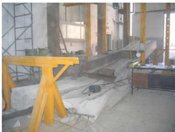
Figura 5 - Collasso a flessione fragile della lastra alveolare TH40
