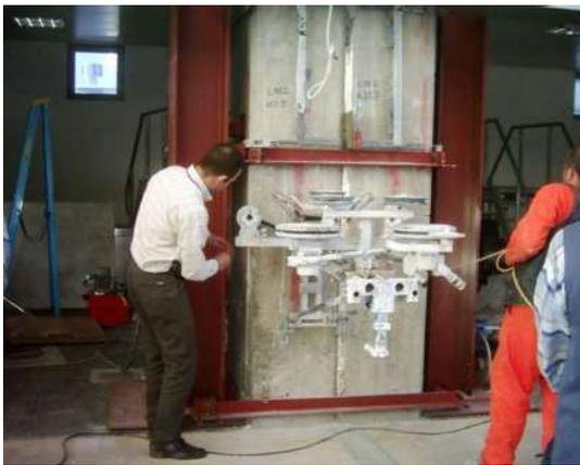
Figura 11 – Taglio dei pilastri con sega a filo diamantato
