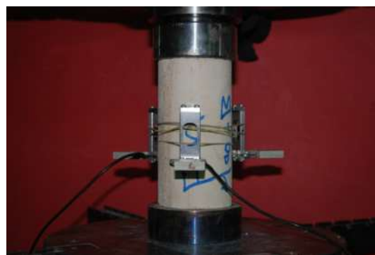
Figura 3 - Apparato sperimentale: (a) pressa elettro-meccanica INSTRON da 100 kN capace di eseguire prove in trazione/compressione in controllo di spostamento, deformazione o carico (si osservino i 3 DD1 resistivi con base 50 mm per la misura della deformazione assiale e per la determinazione del modulo elastico); (b) unità di controllo della pressa e di acquisizione-dati; e (c) provino strumentato.
