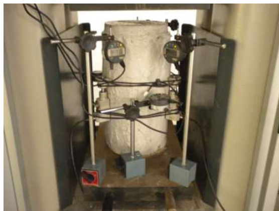
Figura 7 - Set up di prova e acquisizione dati per provini a sezione quadrata
