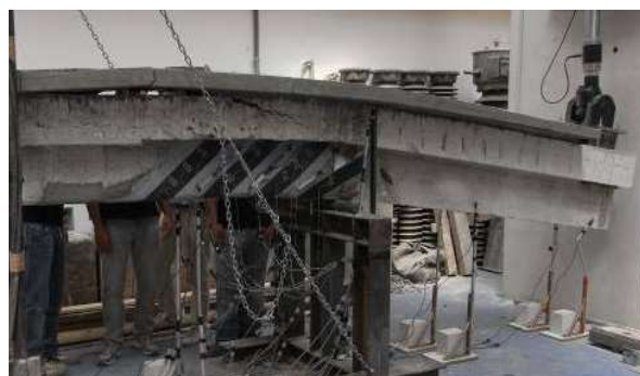
Figura 9 – Trave a seguito del collasso
