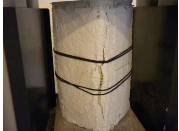
Figura 14 - Rottura provino a sezione quadrata Q3-3S
