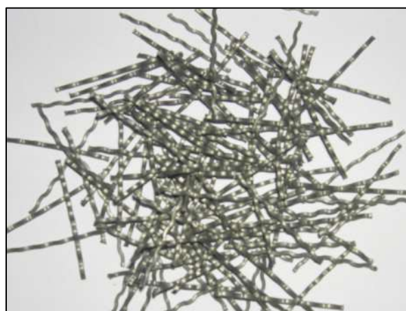
Figura 1 – Macro-fibre in polipropilene lunghe 30 mm con diametro di 0,95 mm
