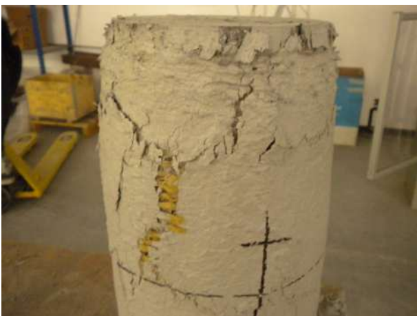
Figura 13 - Rottura provino cilindrico C1-3S
