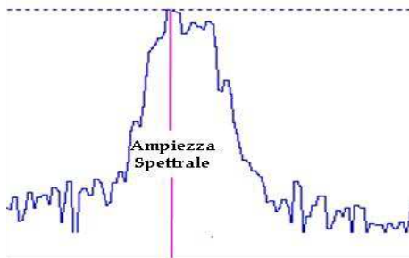
Figura 4 – Valutazione dell'Ampiezza Spettrale AS del segnale ricevuto
