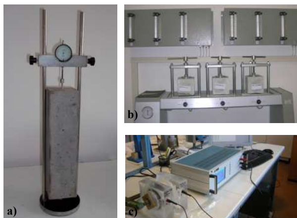
Figura 8 – Alcune delle attrezzature utilizzate nella sperimentazione: comparatore millesimale per la determinazione del ritiro igrometrico (a), permeabilmetro per la valutazione della profondità dell'acqua in pressione (b) e l'apparecchiatura per la esecuzione del Rapid Chloride Penetration Test (c).
