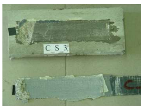
Figura 4: Delaminazione adesiva – S_3
