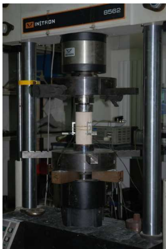
Figura 3 - Apparato sperimentale: (a) pressa elettro-meccanica INSTRON da 100 kN capace di eseguire prove in trazione/compressione in controllo di spostamento, deformazione o carico (si osservino i 3 DD1 resistivi con base 50 mm per la misura della deformazione assiale e per la determinazione del modulo elastico); (b) unità di controllo della pressa e di acquisizione-dati; e (c) provino strumentato.
