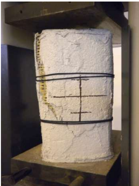
Figura 12 - Rottura provino a sezione quadrata Q2-2S'
