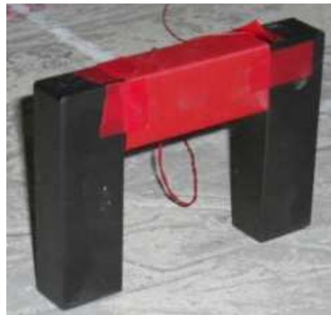
Figura 4. sensore per le misure magnetiche, lato lungo 127 mm, altezza 91 mm, sezione 20x30.
