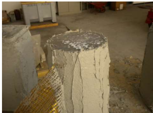
'Figura 5 - Fasi dell'applicazione di malta sul provino cilindrico.'
