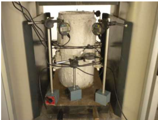
Figura 6 - Set up di prova e acquisizione dati per i provini cilindrici'
