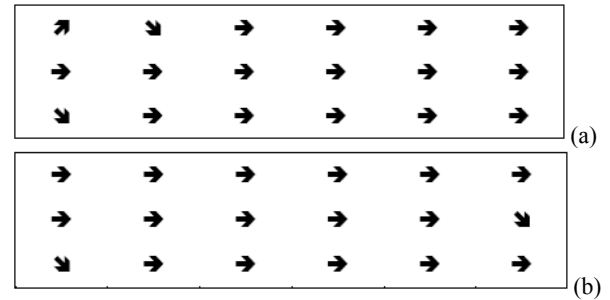
Figura 5: direzioni di massima induttanza incrementale nelle lastre HPFRCC-50 (a) ed HPFRCC-100 (b)
