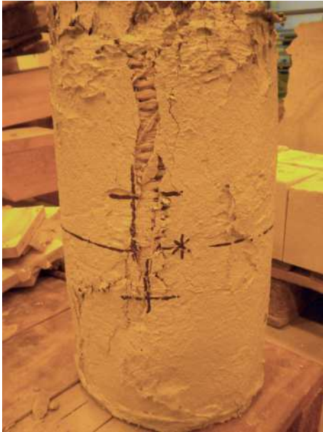
Figura 11 - Rottura provino cilindrico C2-2S
