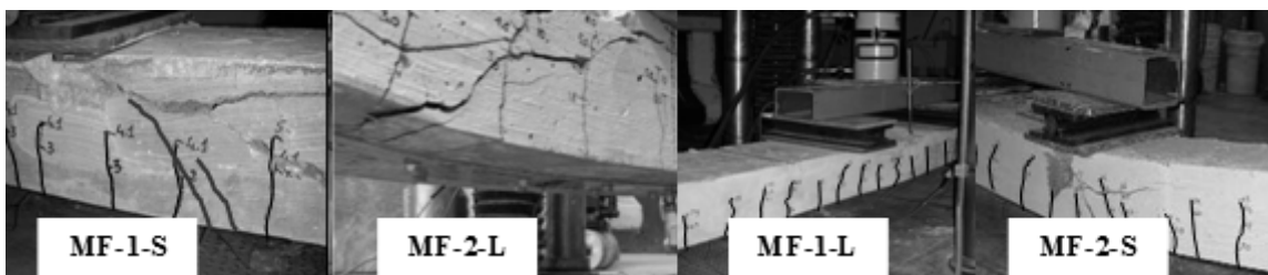
Figura 9 – Modalità di collasso: provini rinforzati con lamine MF-FRP
