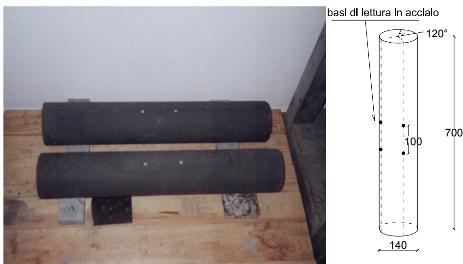
Figura 5 - Provini per determinare il ritiro superficiale
