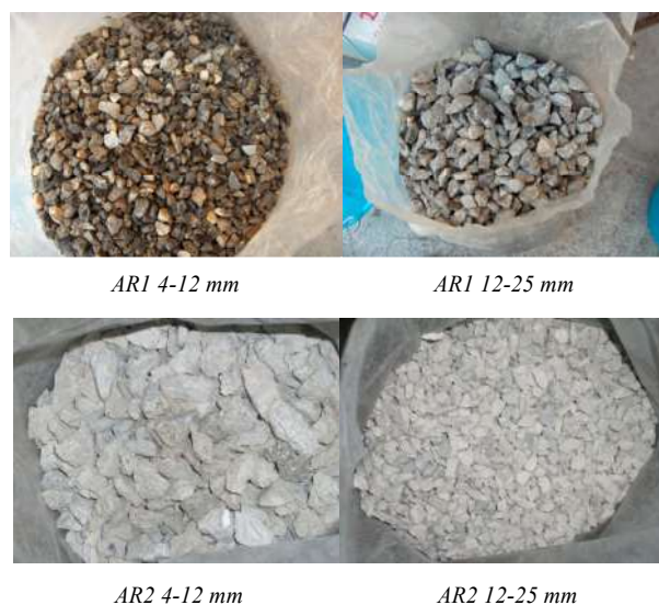
Figura 1 – Esempi di aggregati riciclati impiegati nelle indagini sperimentali per diverse granulometrie
