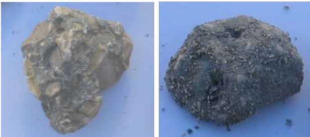
Figura 8 - Effetto "cortina" a sinistra aggregato grosso miscela R100 B a destra aggregato grosso miscela R51 B [10]
