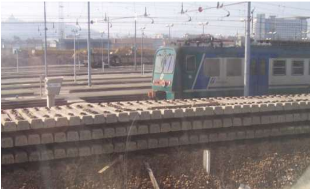
Figura 1 - Traverse ferroviarie monoblocco in calcestruzzo armato precompresso, stazione di Bologna
