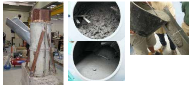
Figura 4 - (a) Cassaforma, (b) preparazione SCC, (c) getto SCC
