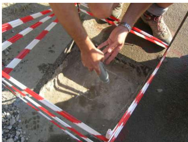
Figura 3 – Battuta sclerometria sulla soletta
