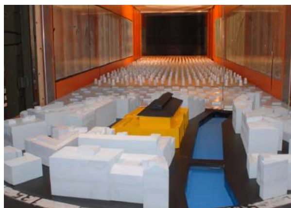
Figura 7 - Modello del Mercato in galleria del vento
