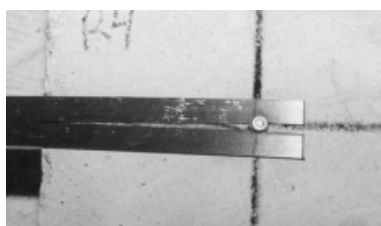
Figura 2 – Rottura per “splitting” delle lamine [5]
