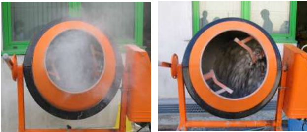
Figura 7 - Miscelazione a secco degli aggregati, effetto della prebagnatura
