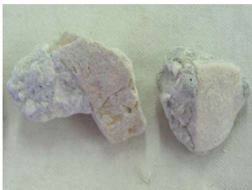
Figura 3 - Malta cementizia attaccata agli aggregati originari
