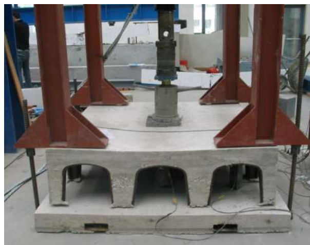
Figura 7 - Vista globale del Test 6 a rottura. Si noti la significativa deformata flessionale dell'elemento
