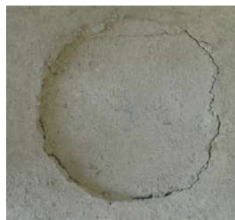
Figura 6 - Fessurazione per punzonamento, provino 1, serie 1
