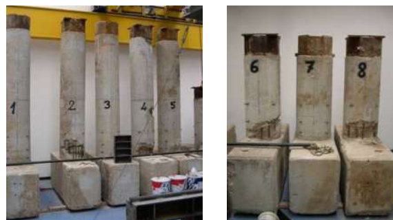
Figura 2 – Stato dei provini: alti (1, 2, 3, 4, 5) e bassi (6, 7, 8)
