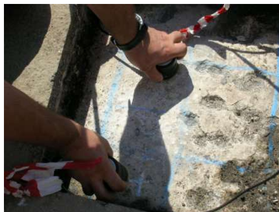
Figura 4 – Battuta ultrasoniche sulla soletta
