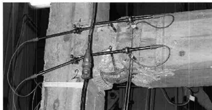
Fig. 4 - Prove distruttive con azioni cicliche su nodi di telai sperimentali in scala ridotta in RAC
