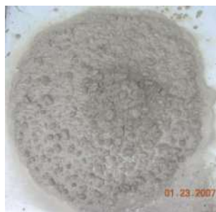
Figura 2 – Limite di segregazione raggiunto da una miscela poco robusta (senza cenere volante) a seguito di una riaggiunta di acqua
