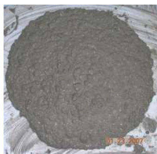
Figura 3 – Stessa miscela di figura 2 con l'aggiunta di 80 \text{ kg/m}^3 di cenere volante Micro Pozz PFA. Con la stessa riaggiunta di acqua l'impasto rimane omogeneo.
