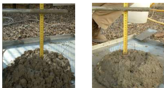
Figura 5 – Aspetto visivo di un impasto poco robusto (a sinistra) e dello stesso impasto con 80 kg/m 3 di cenere volante Micro Pozz PFA
