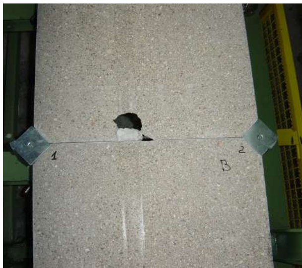
Figura 7 – Tipica rottura per fatica (vista dall'alto).
