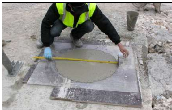
Figura 6 - Esempio di slump flow test eseguito prima dello scarico di nuovo materiale.
