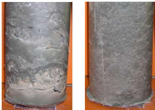
Figura 1 – Effetto dovuto ad aggiunte di acqua in miscele poco robuste, a sinistra, e molto robuste grazie all'utilizzo di cenere volante Micro Pozz PFA, a destra
