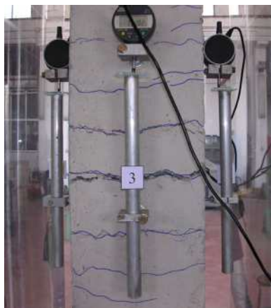
Figura 5 - Fessurazione della regione tesa della colonna.
