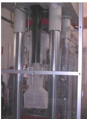
Figura 2 - Test set-up per la prova di compressione eccentrica.
