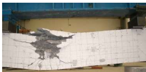
Figura 7: Quadro fessurativo a rottura del provino 4φ16-B-30
