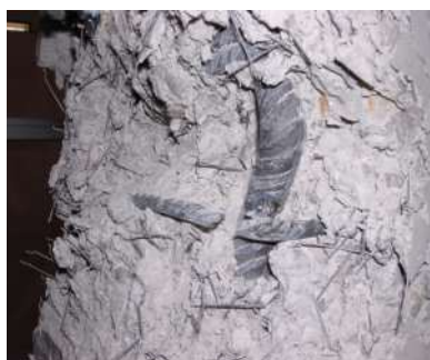
Figura 6 - Stato di un campione a fine prova ( \delta=10 mm e V_f=1\% ).
