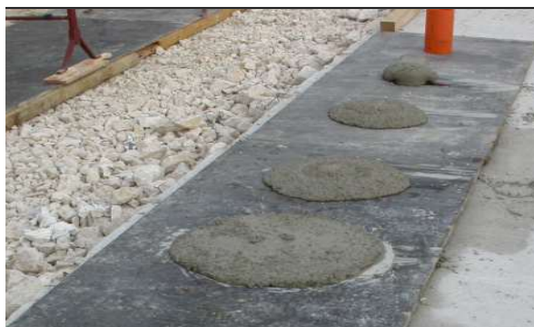
Figura 7 - Esempio di slump flow test eseguiti su campioni di SCC mantenuti a riposo.
