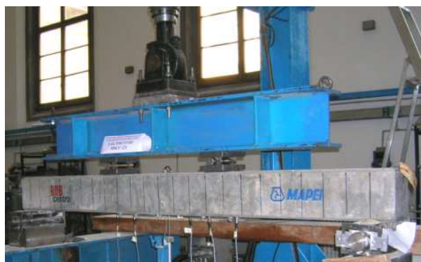
Figura 3 – Una trave prima della prova di carico
