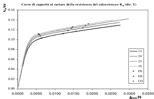
Figura 11. Curve di Capacità direzione Y [ f_{sy, travi} = 320 MPa]
