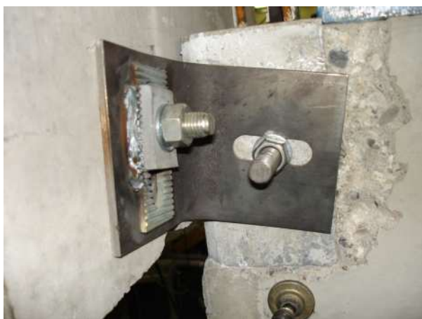
Fig.18 – Seconda prova: particolare della connessione
