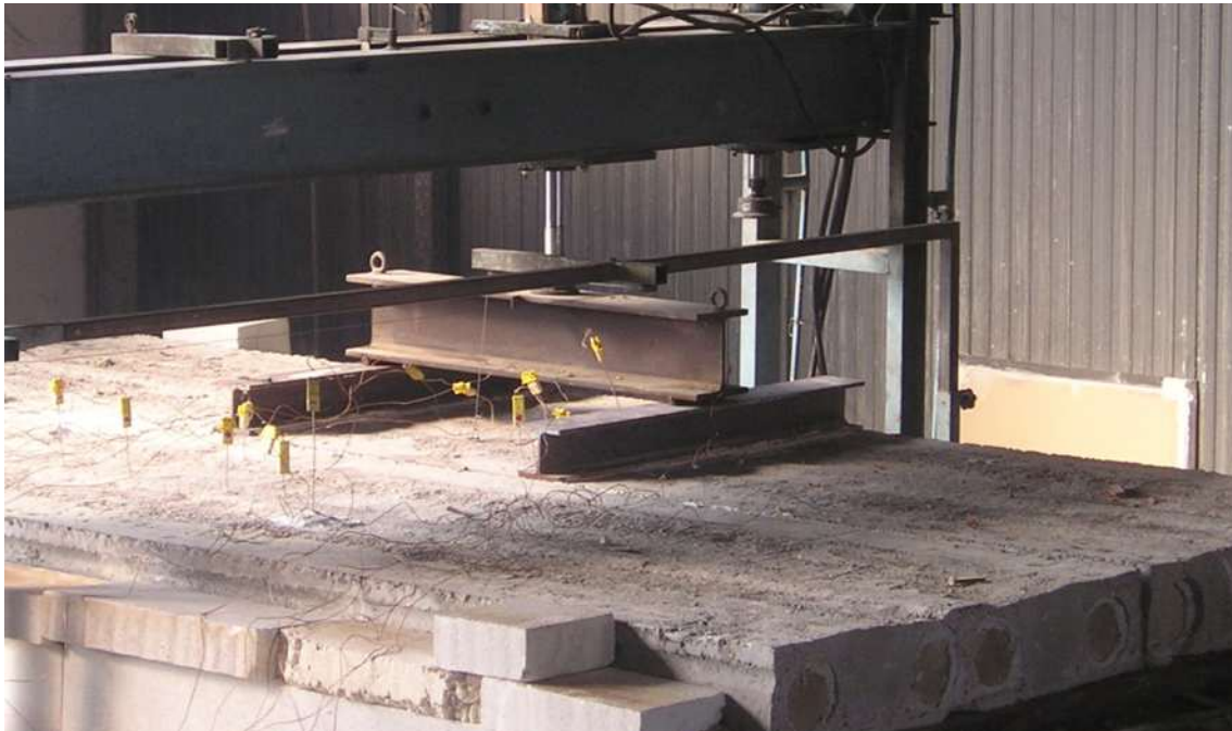
Figura 1. Configurazione sperimentale relativa alla seconda prova al forno. E' visibile la sigillatura dei fori.
