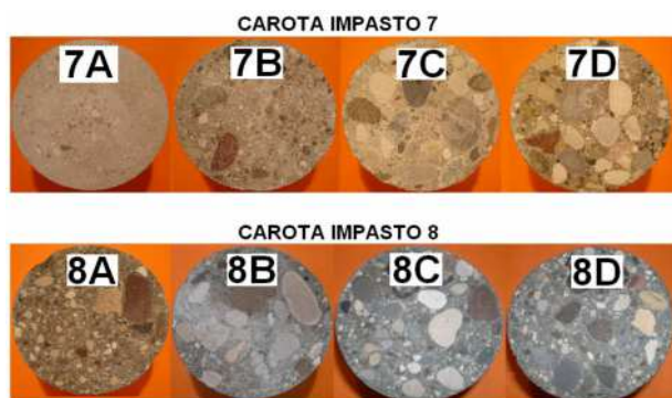
Figura 6 – Provini ricavati dalle carote relative agli impasti 7 (solo cemento) e 8 (cemento più cenere volante Micro Pozz PFA).
