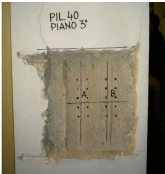
Figura 8 - Indicazione dei punti scelti per la valutazione dell'indice di rimbalzo
