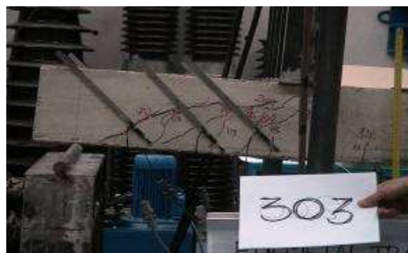
Figura 14 – Trave G. Quadro fessurativo al termine della prova a taglio.
