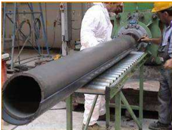
Figura 1 – Schema di processo di estrusione di tubi
