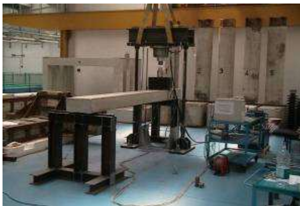
Figura 9 – Organizzazione delle prove di Flessione e Taglio
