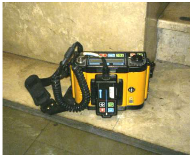
Figura 6 – Pacometro impiegato nella sperimentazione
