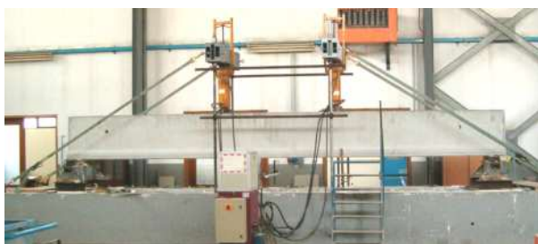
Figura 4 - Prova su travi in c.a.: schema (sopra) e svolgimento (sotto)
