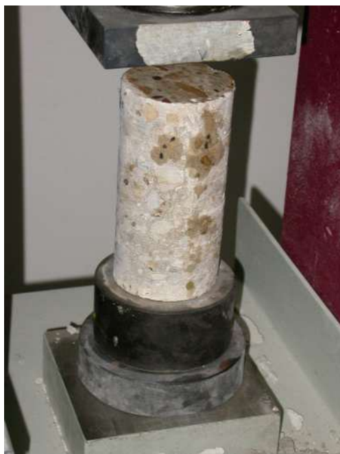
Figura 12 - Prova di compressione su carota di calcestruzzo
