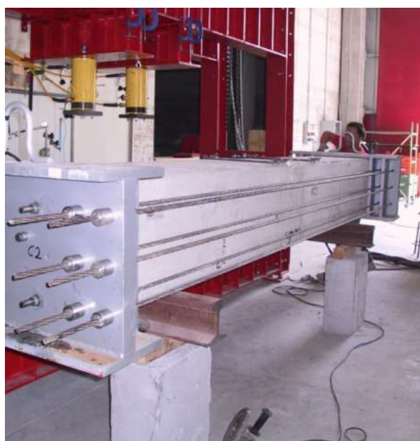
Figura 11 - Prova di pressoflessione: foto del provino prima della prova.
