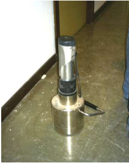
Figura 7 – Sclerometro impiegato nella sperimentazione
