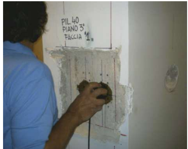
Figura 9 - Misura dell'impulso ultrasonico
