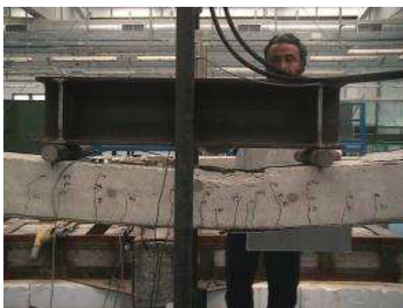
Figura 13 – Quadro fessurativo della trave C a rottura.
