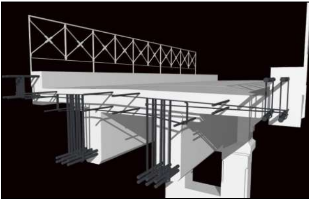
Figura 1 – Armature di travi con sistema Hennebique (Viadotto in Corso Italia a Bari, 1914)
