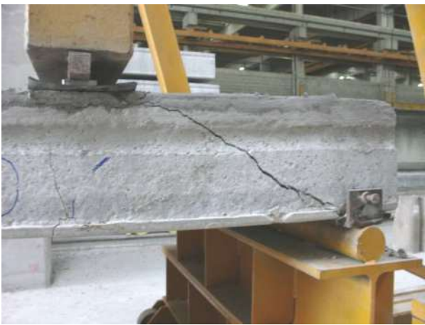
Figura 6 - Prova di taglio su solaio alveolare
