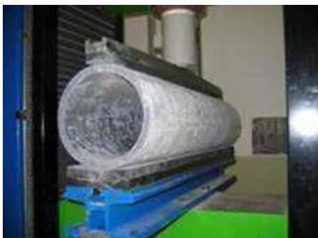
Figura 7 – Prova a schiacciamento secondo UNI EN 588-1
