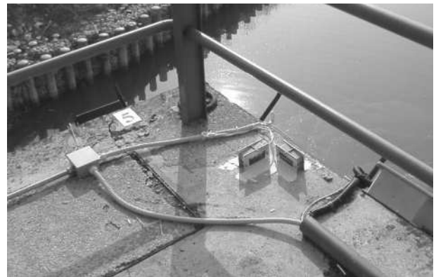
Disposizione di due clinometri e di un fessurimetro per monitoraggio lesione 5
