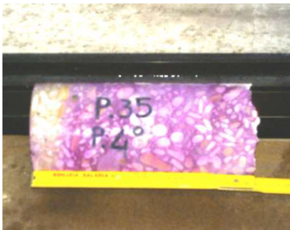
Figura 10 – Risultato del test colorimetrico su carota estratta
