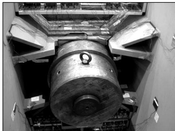
Figure 14 – modello in scala reale dell'ancoraggio strallo sulla torre
