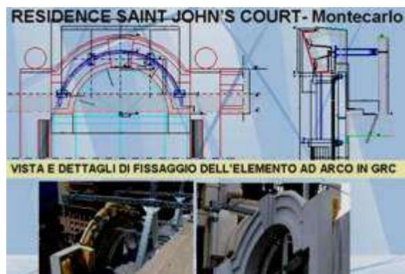
Figura 21 – Vista e dettagli modanature in GRC – TX ACTIVE
