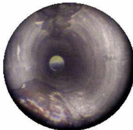
Figura 9 – Endoscopia con evidenza di segregazione del cls
