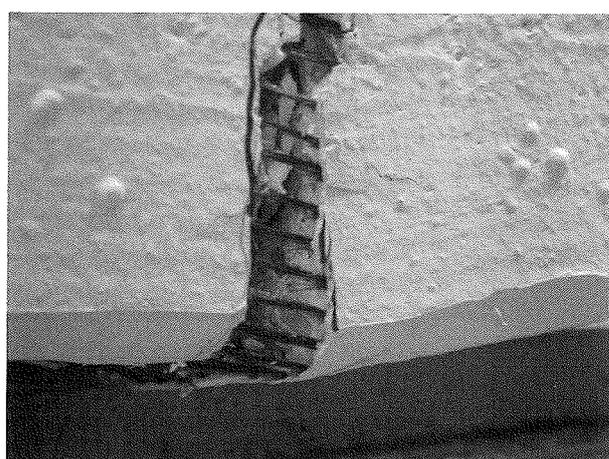
Figura 14 d. - Provino C2. Dettaglio della crisi in zona tesa.
